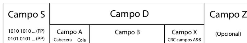
Figura 2.4: Estructura del paquete DECT
