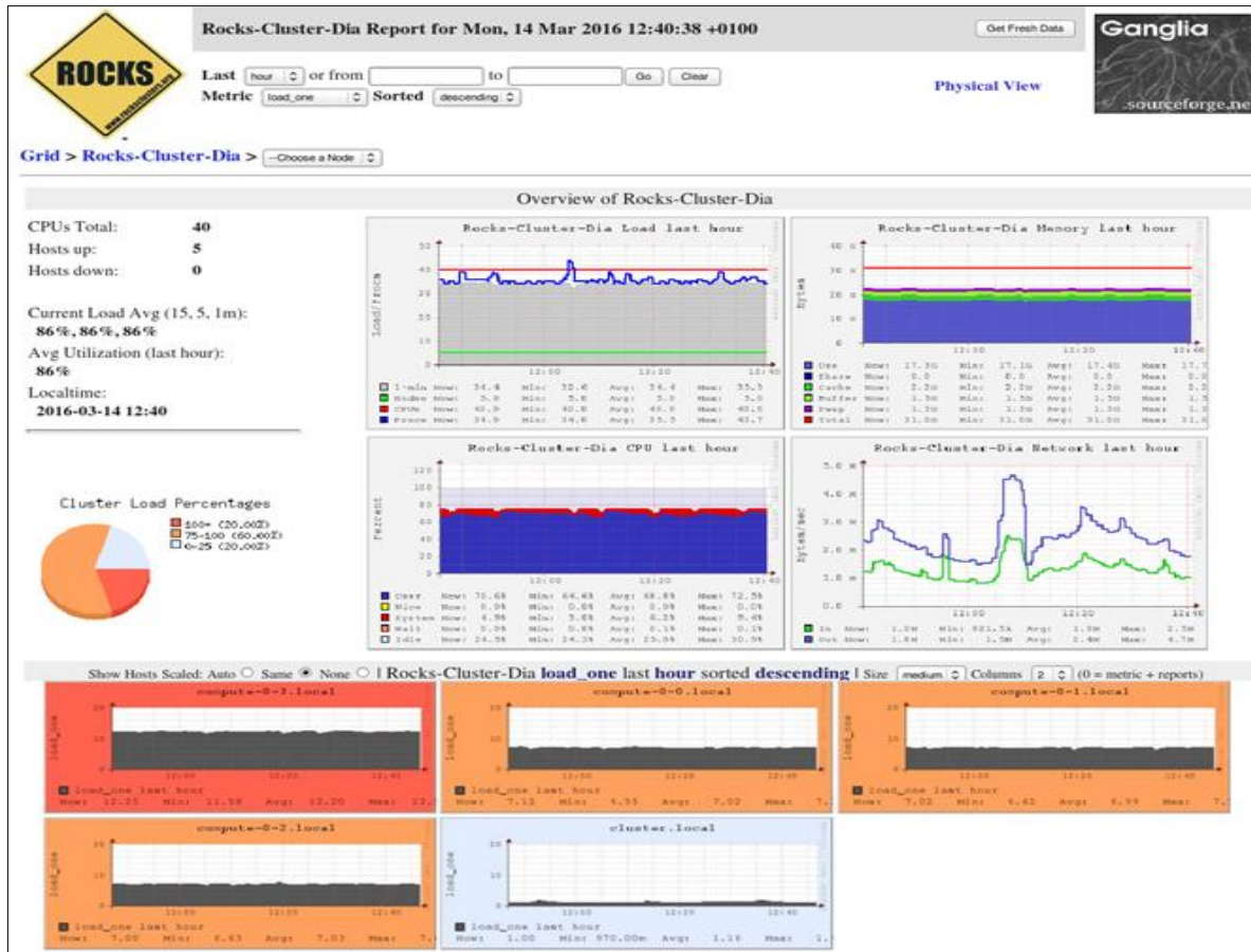
Figura 2.22. Consola de monitorización Ganglia del clúster DIA. Se puede apreciar el estado de trabajo de los cuatro nodos en rojo-naranja y en azul el nodo front-end.
