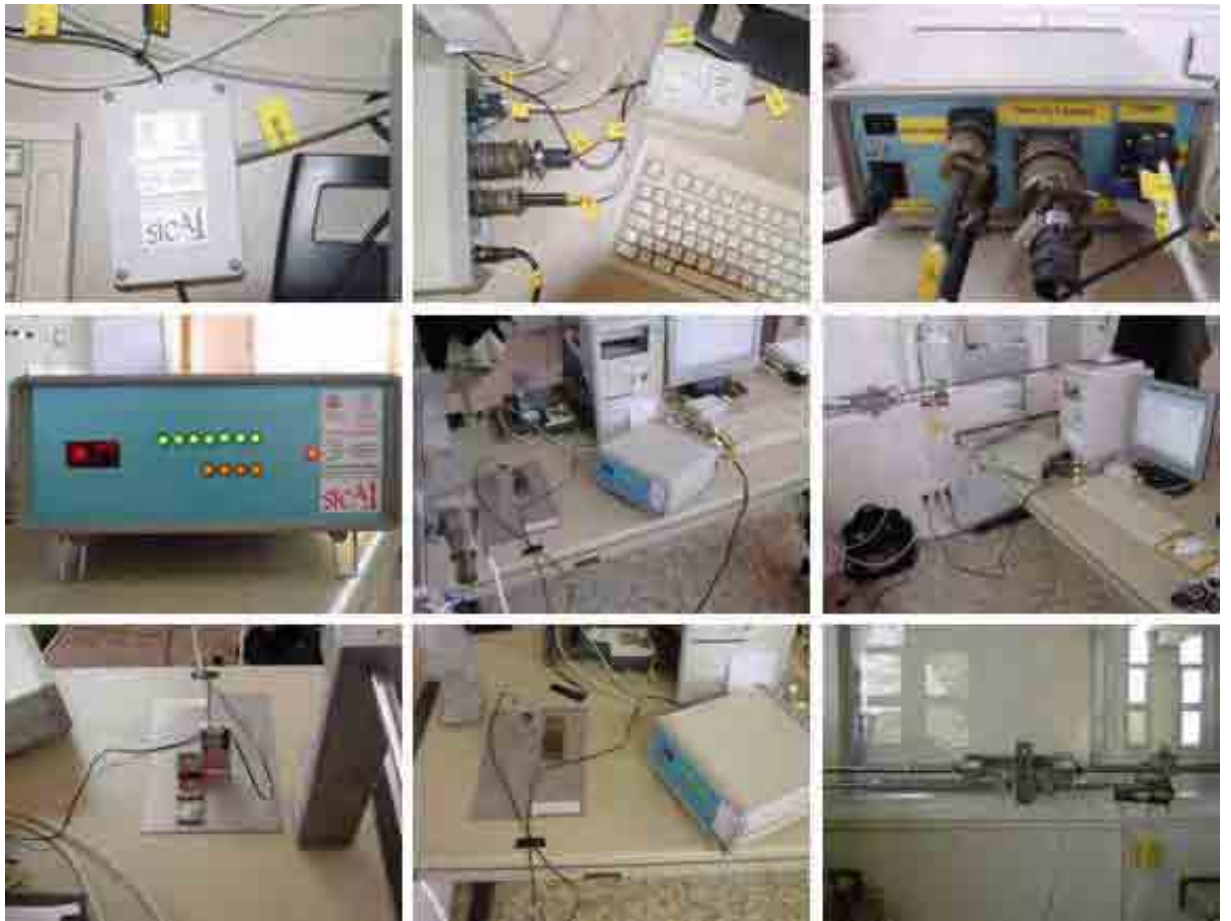
Figura 3.32: Sistema para inspección superficial de acero inoxidable SICA I
