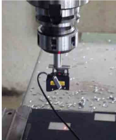
Figura 3.29: El cabezal láser se montó en un centro de mecanizado, el cual barrió a una velocidad de 1 m/min dos planchas diferentes.
