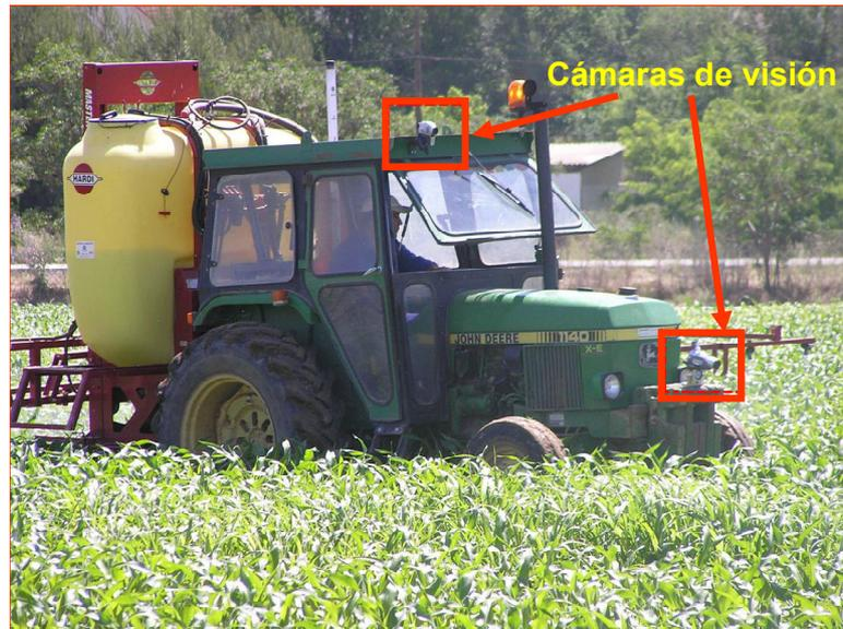
**Figura 1-3: Sistema experimental de cámaras con proyección de perspectiva.**
