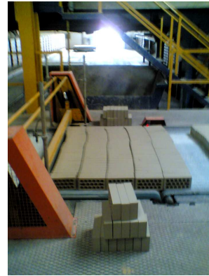
Fotos 5.3.19 y 5.3.20 Maquina de apilado: Paso 1 agrupado de piezas, dos vistas 2009
