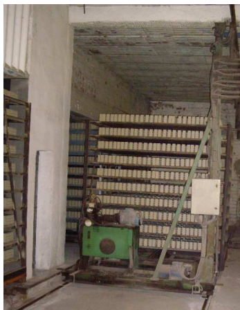
Foto5.3.13 y 5.3.14 Vagoneta de traslado de materiales a entrada de túnel de secado. 2009.
