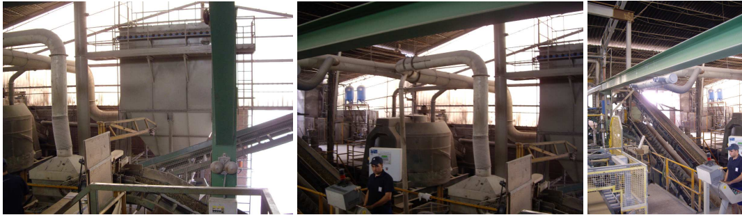
Foto 5.3.4 Vistas de zona de triturado de la arcilla: molinos y cintas transportadoras en 2009. Fuente: elaboración propia
