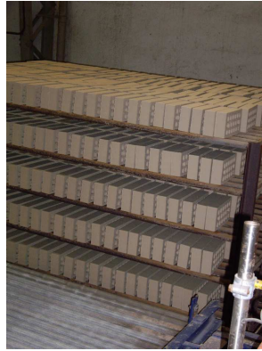
Fotos 5.3.18 La bandeja de material a la salida del secadero es conducida a la apiladora en donde se van depositando las piezas de las bandejas de forma progresiva en la cinta transportadora. 2009.
