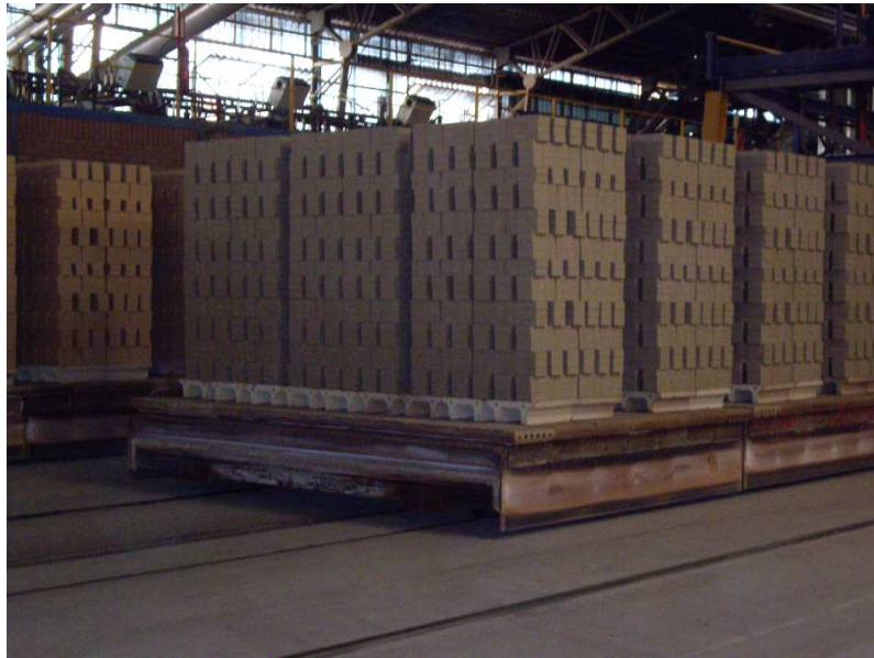
Foto 5.3.17 Tren de carretillas a la entrada al prehorno con 12 palets por vagoneta .2009. Fuente: elaboración propia
