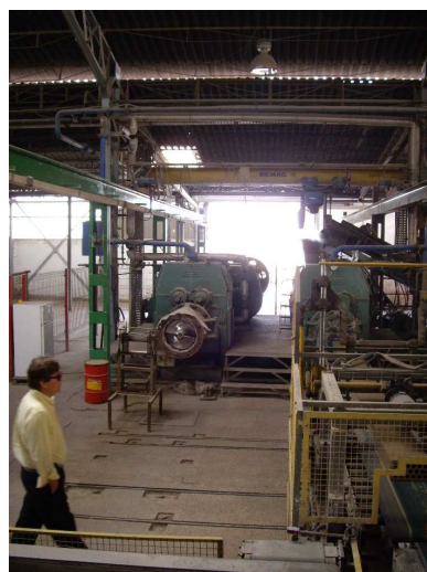
Foto 5.3.5 Zona de extrusión: dos extrusoras en paralelo para mantenimiento y cambio de salidas2009. Fuente: elaboración propia
