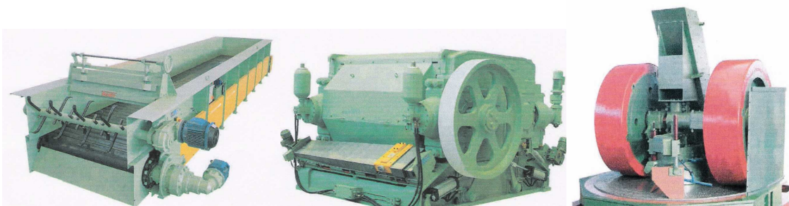
Fig. 2.3.3-2 Alimentador lineal, laminador y molino de rulos. Fuente: Felipe Verdés SA Maquinaria para la preparación cerámica Año 2009
