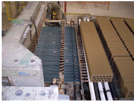
Foto 5.3.10 Área de cortado, vista lateral del proceso de corte de las piezas 2009. Fuente: elaboración propia
