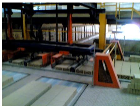
Fotos 5.3.21 y 5.3.22 Maquina de apilado: Paso 2, desagrupamiento de las filas y separación en tres grupos de filas correspondientes a la disposición ladrillos en tres palets 2009
