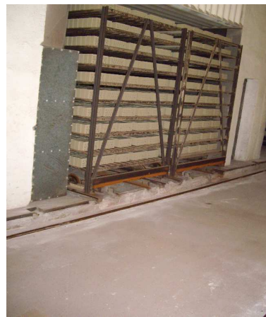
Foto5.3.13 y 5.3.14 Vagoneta de traslado de materiales a entrada de túnel de secado. 2009.
