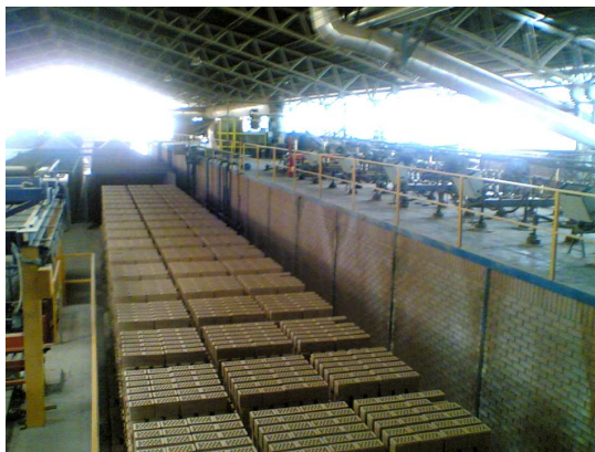
Fotos 5.3.25 y 5.3.26 Vista general de las piezas a la entrada del horno túnel, situado a la derecha. En la parte superior están situados todos los mecheros y sus tuberías de alimentación de gas natural. 2009
