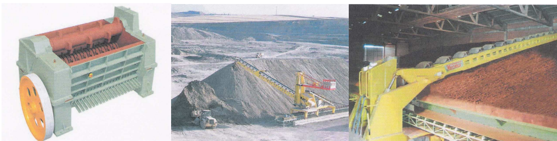
Fig.2.3.3-1 Desmenuzador, amontonadoras actuales y dragas Fuente: Felipe Verdés SA Maquinaria para la preparación cerámica Año 2009
