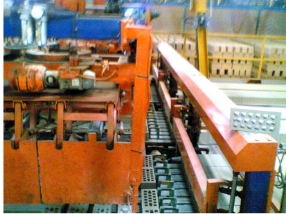
Fotos 5.3.23 y 5.3.24. Máquina de apilado: Paso3 colocación de piezas por filas en los tres palets, dos vistas.2009
