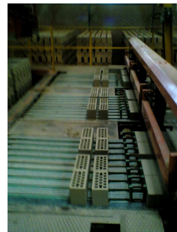
Fotos 5.3.21 y 5.3.22 Maquina de apilado: Paso 2, desagrupamiento de las filas y separación en tres grupos de filas correspondientes a la disposición ladrillos en tres palets 2009
