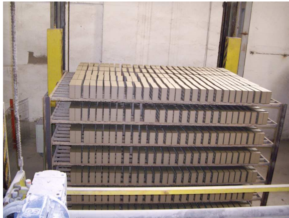
Foto 5.3.11 y 5.3.12 Apilado automático para el traslado a la cámara de secado 2009. Fuente: elaboración propia
