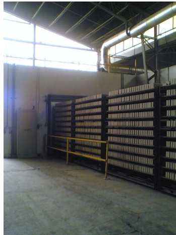
Foto 5.3.16 Carretillas a la salida del secadero hacia la zona de paletización previa al horno.2009. Fuente: elaboración propia
