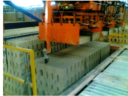
Fotos 5.3.23 y 5.3.24. Máquina de apilado: Paso3 colocación de piezas por filas en los tres palets, dos vistas.2009
