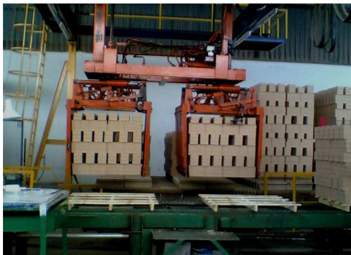
Foto 5.3.31 Formación de palets . Paso 2. Traslado hacia la cinta con los bastidores de madera. 2009. Fuente: elaboración propia
