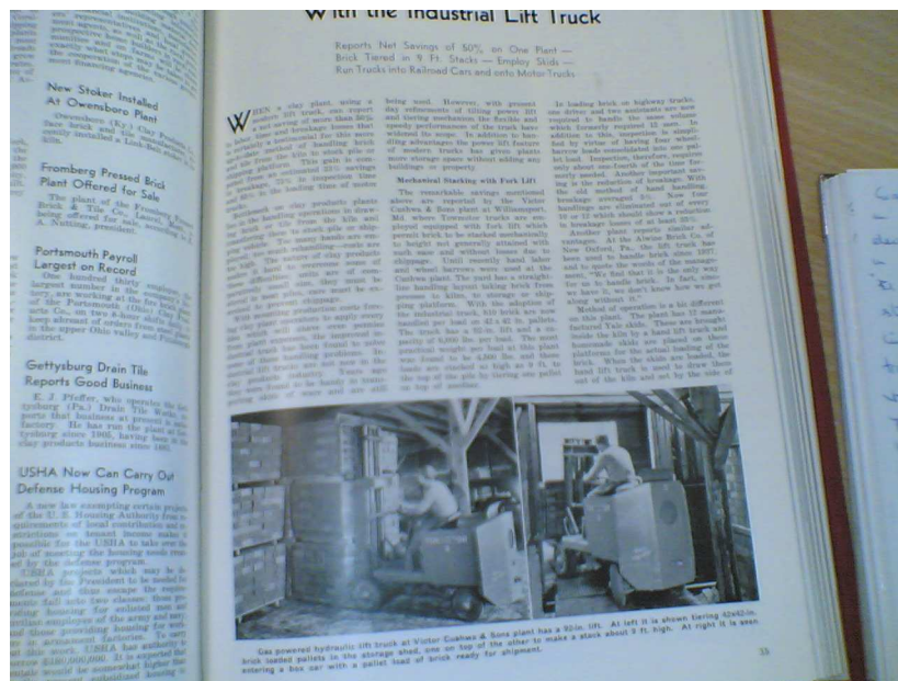
Figura.2.8.2-3 Movimiento de paquetes de ladrillo en fabrica mediante carretillas en 1940 en EEUU.
