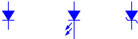
Figura 5. Símbolos usuales para la representación de diodos.
