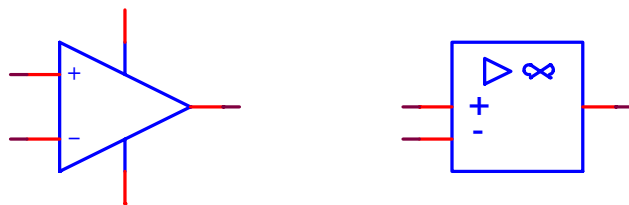
Figura 11. Símbolo usual (izquierda) y normalizado (derecha) para representar un A.O.
