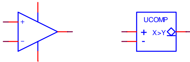
Figura 10. Símbolo usual (izquierda) y normalizado (derecha) para representar un comparador integrado.
