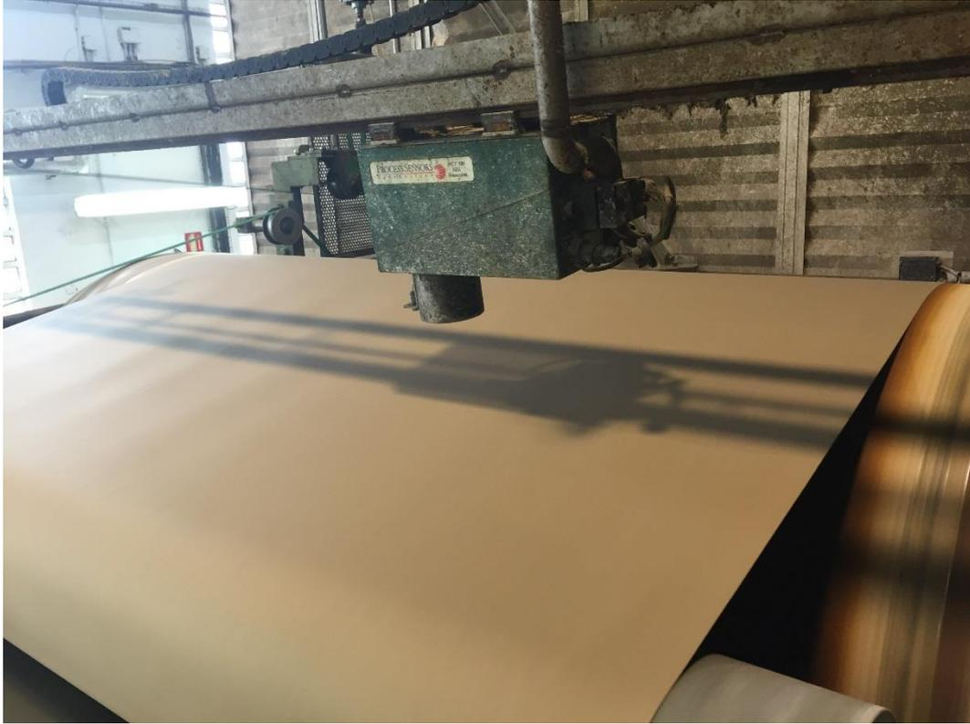
Figura 3.5. Medición de humedad ( $P_{mi}$ ) y temperatura ( $P_{ti}$ ) del papel recogidos por el QCS.
