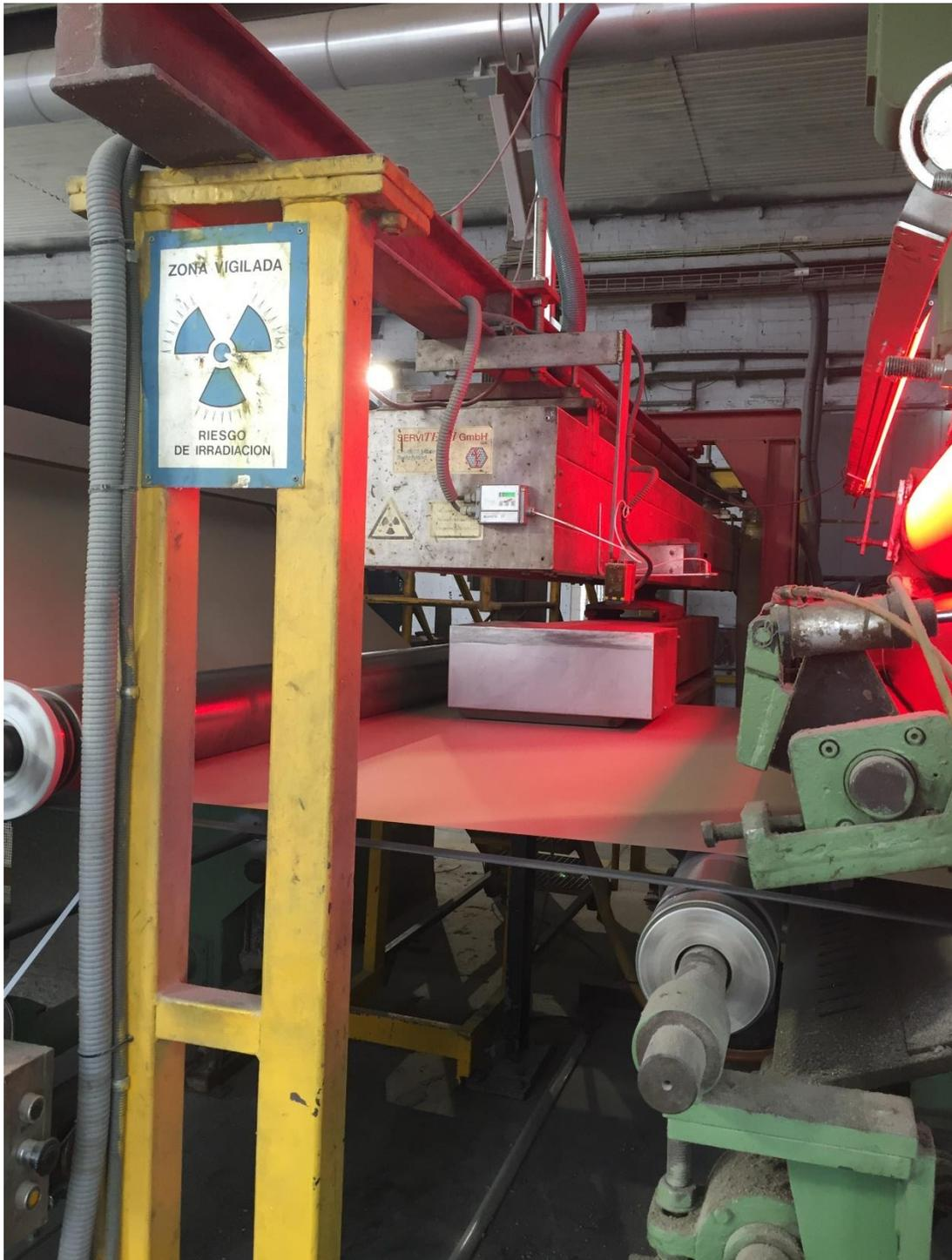
Figura 3.7. Medición de densidad superficial ( $Pd$ ), humedad ( $Pmo$ ) y temperatura ( $Pto$ ) del papel recogidos por el QCS.
