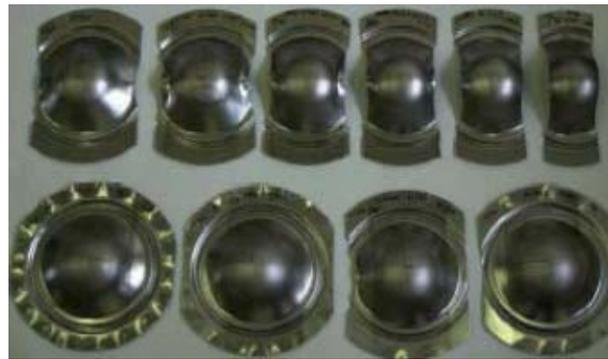
Figura 3.20 Probetas utilizadas para la determinación de la Curva Límite de Conformado de un material
