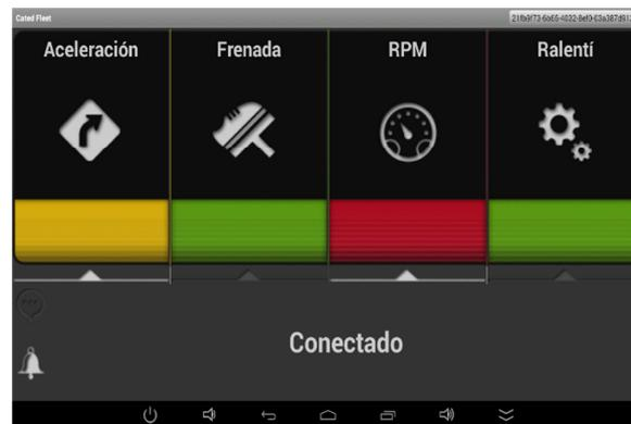
Figura 27: Alarma roja de revoluciones de motor (RPM) en el asistente embarcado
