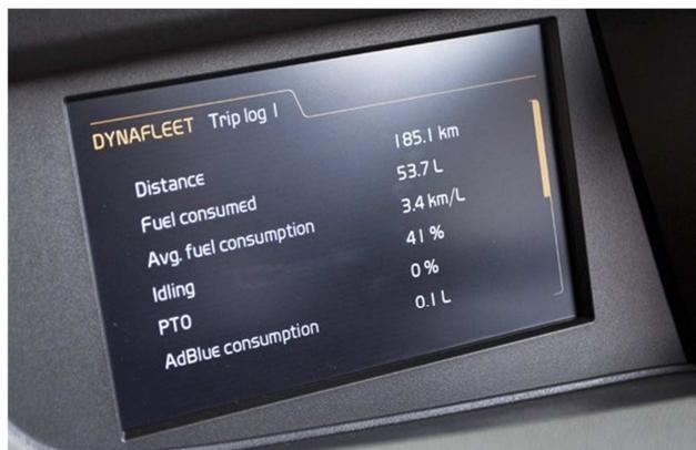
Figura 5: Módulo asistente embarcado de Volvo para proporcionar información al conductor
