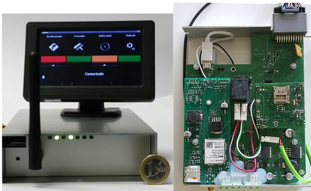
Figura 36: Componentes del sistema hardware embarcado
