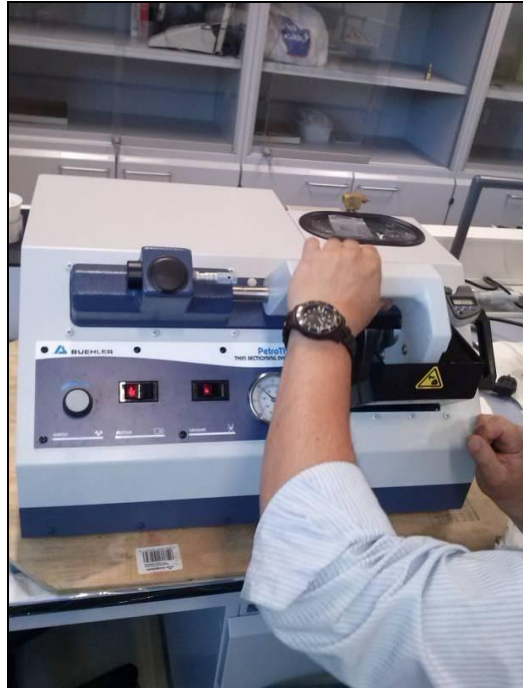
Figura 11. Máquina cortadora y preparadora de láminas delgadas (SCCYT, UCA).
