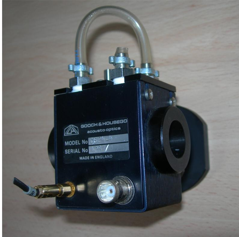
**Figura 5.53** AOM utilizado para la comprobación experimental de la interacción acusto-óptica
