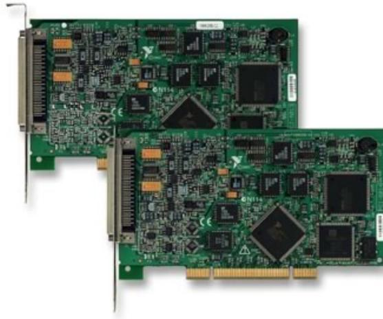
**Figura 5.16** Tarjeta de adquisición de datos NI PCI-6013
