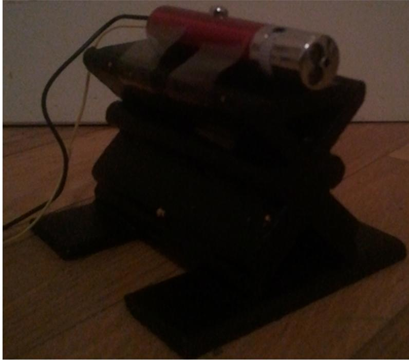
**Figura 5.54** Láser de diodo utilizado para la comprobación experimental de la interacción acusto-óptica
