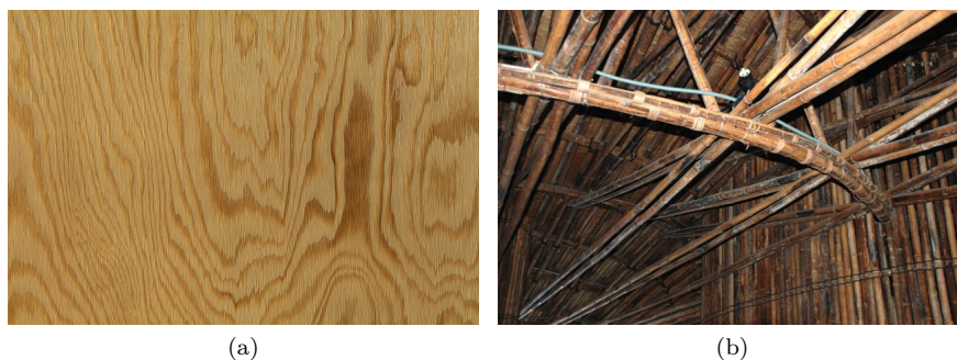
Figura 4.1: Ejemplos de materiales compuestos naturales: (a) textura de madera [30], (b) estructura de bambú [31].
