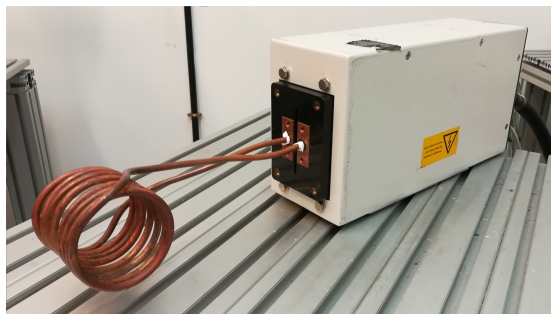
Figura 6.8: Bobina de inducción para generación de corrientes en inspecciones por termografía activa.
