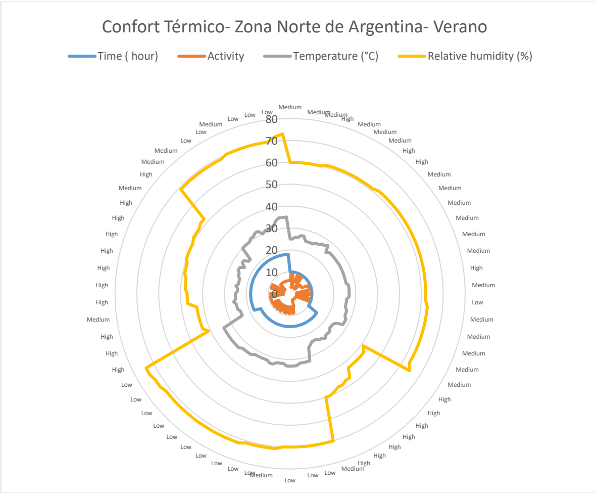
Figura 10. Confort térmico en función de la actividad, temperatura interior, humedad relativa y horario. Zona norte de Argentina. Verano
