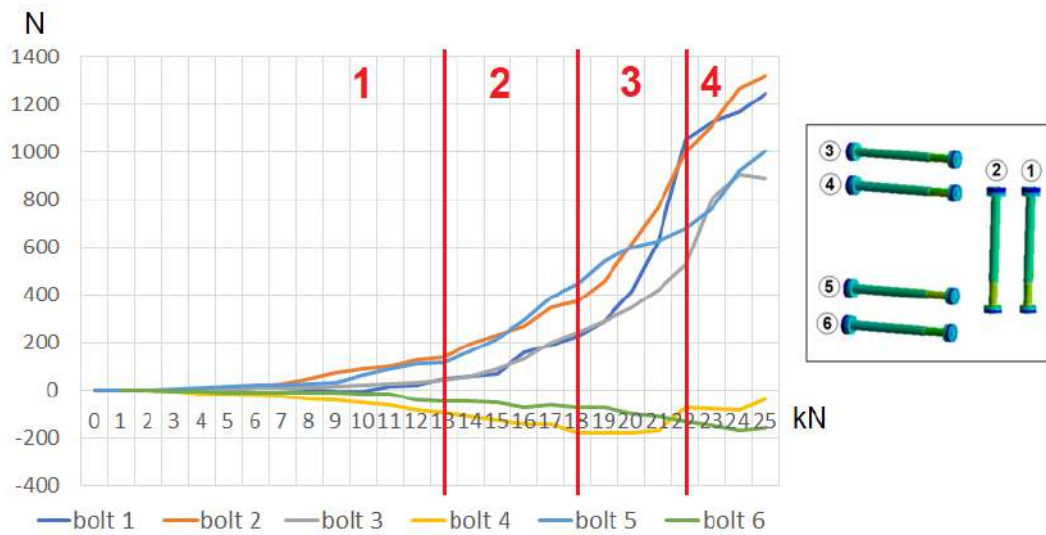
Figura 5.35 Valor del aumento del axil soportado de los tornillos en cada uno de los cuatro modos de trabajo.
