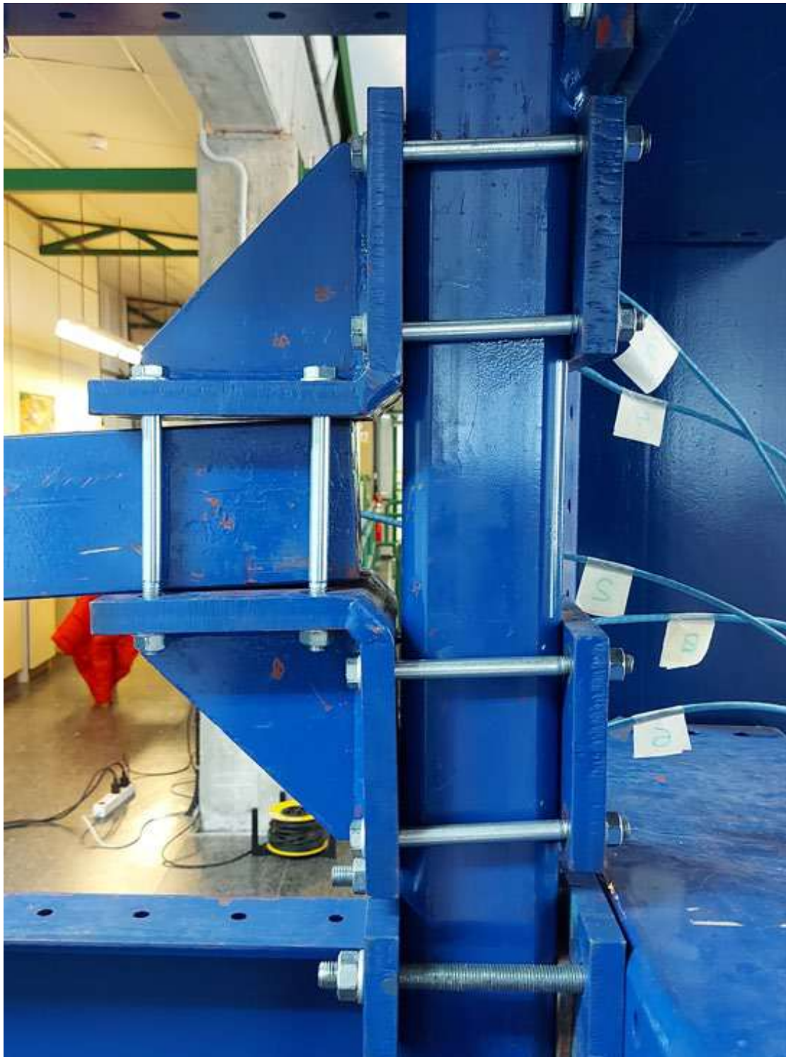
Figura 5.32 Detalle de la deformación de la unión por la cara trasera de la prensa.
