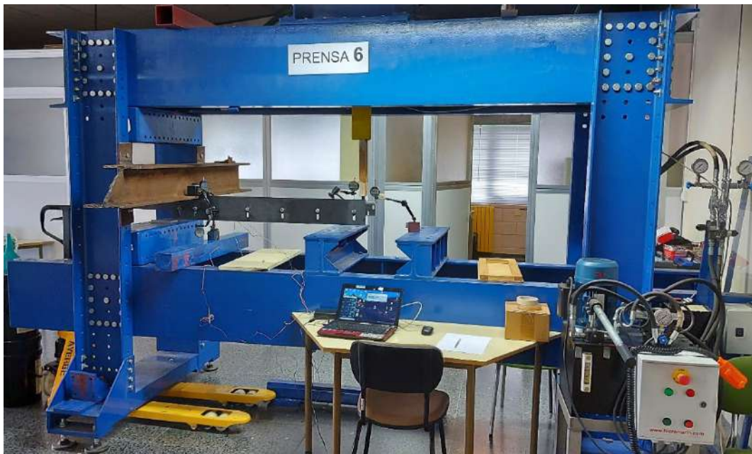
Figura 6.15 Imagen de la prensa de 300kN de ensayos estáticos, del laboratorio de estructuras de la Universidad de Vigo, con el sistema de anclaje de pasarela montado para el ensayo.
