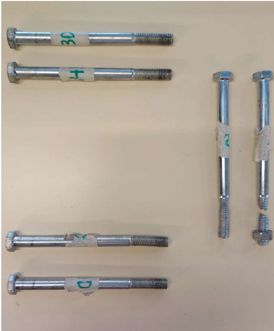
Figura 5.31 Detalle de los tornillos de la cara frontal dañados por la plastificación.
