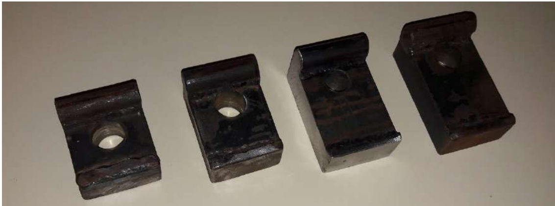
Figura 2.15 Imagen de los cuatro valores diferentes de palanca delantera de grapa empleados en los ensayos: 19, 29, 39 y 44 mm.
