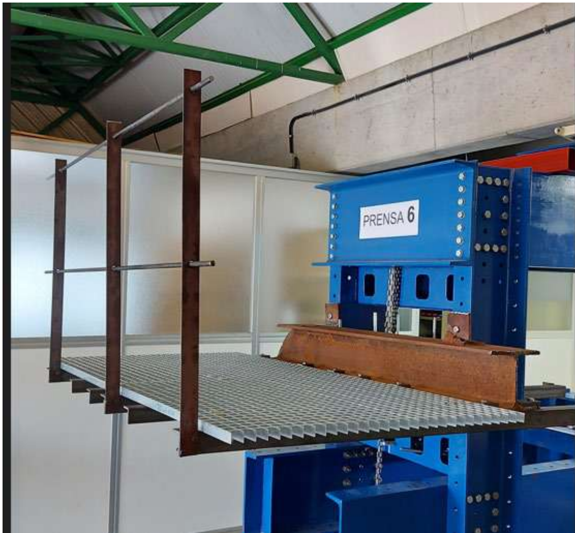
Figura 6.21 Sistema de plataforma desmontable montada en laboratorio.
