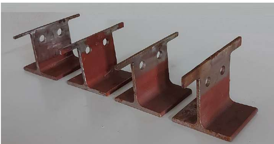
Figura 2.14 Probetas en forma de T a partir de un perfil laminado IPE220.
