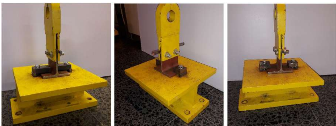
Figura 2.16 Diferentes tamaños de grapas montados en el ensayo. a) Palanca delantera de 44 mm. b) Palanca delantera de 29 mm. c) Palanca delantera de 19 mm.
