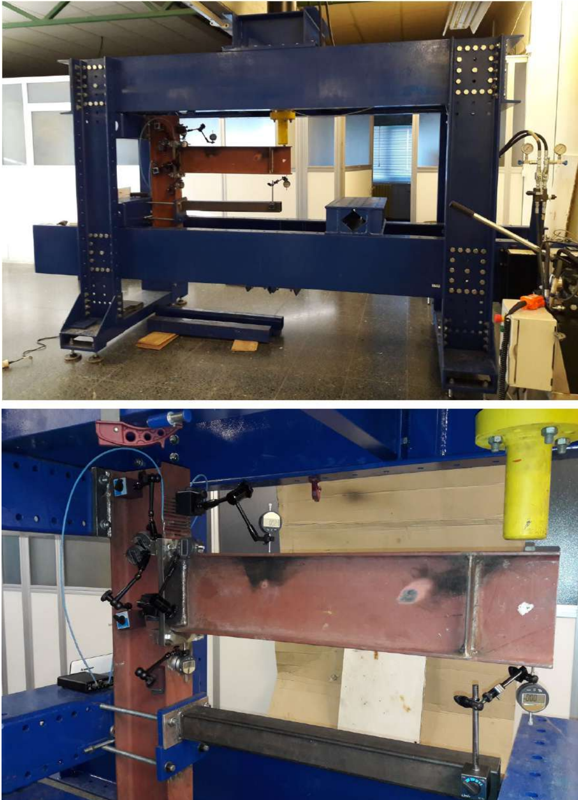
Figura 4.12. a) Prensa de ensayos con la unión grapada montada para ensayar (Cabaleiro et al. 2020). b) Montaje de viga y pilar con su correspondiente unión grapada para realizar los ensayos en la prensa de laboratorio.
