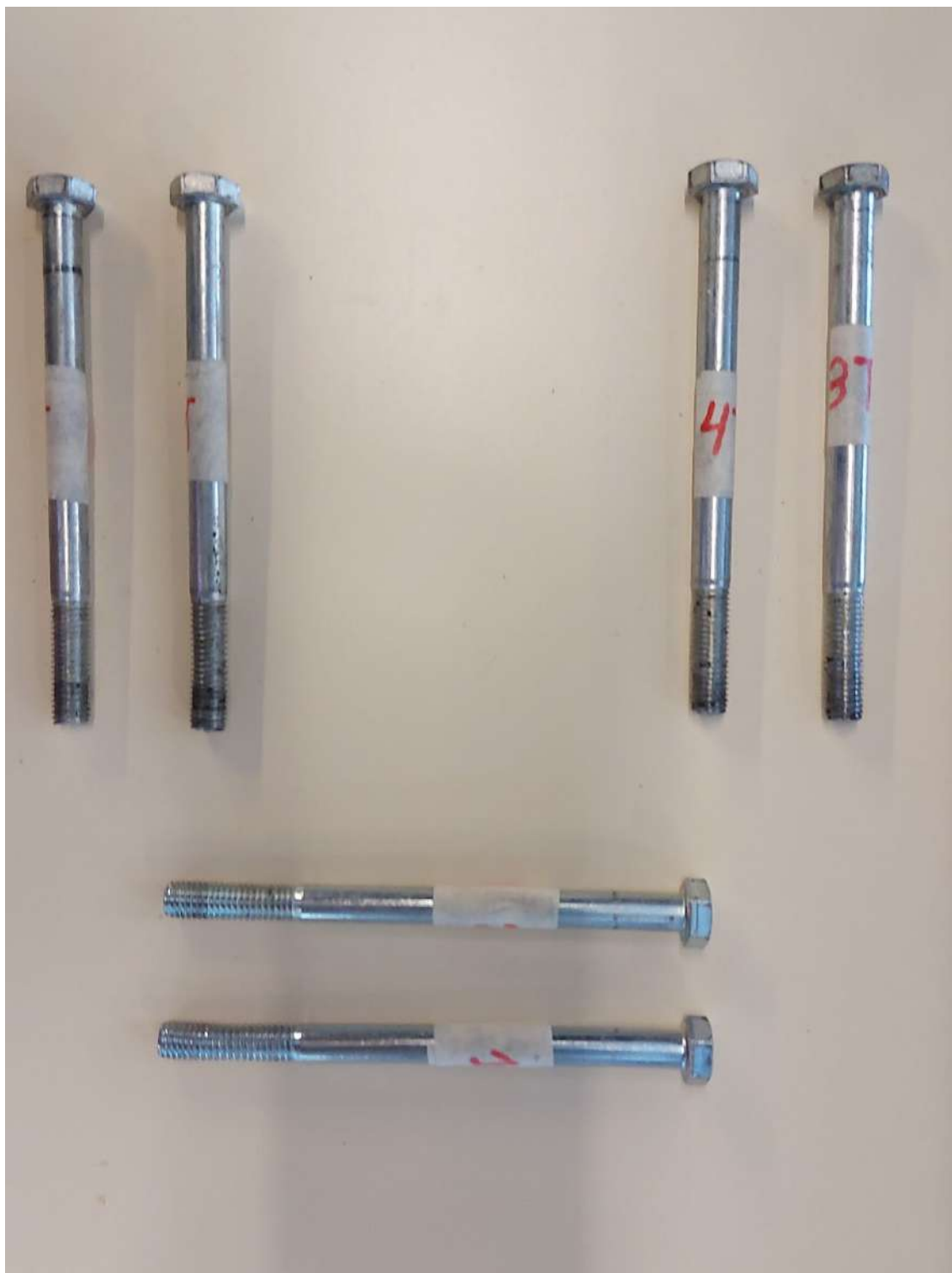
Figura 5.33 Detalle de los tornillos de la cara trasera dañados por la plastificación.
