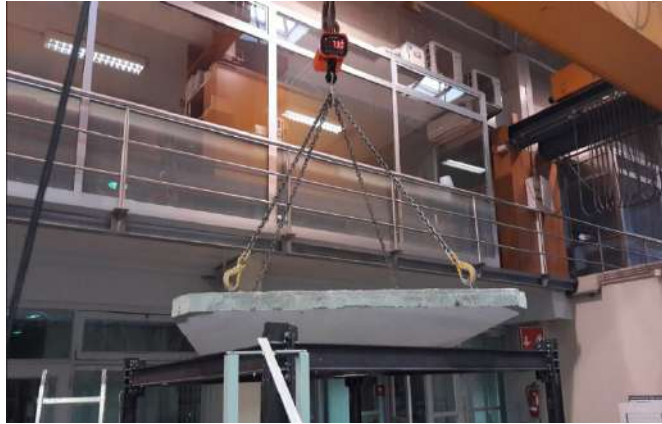
Figura 3.13 Pesado y montaje de la losa en el pórtico a ensayar en la mesa sísmica de laboratorio.
