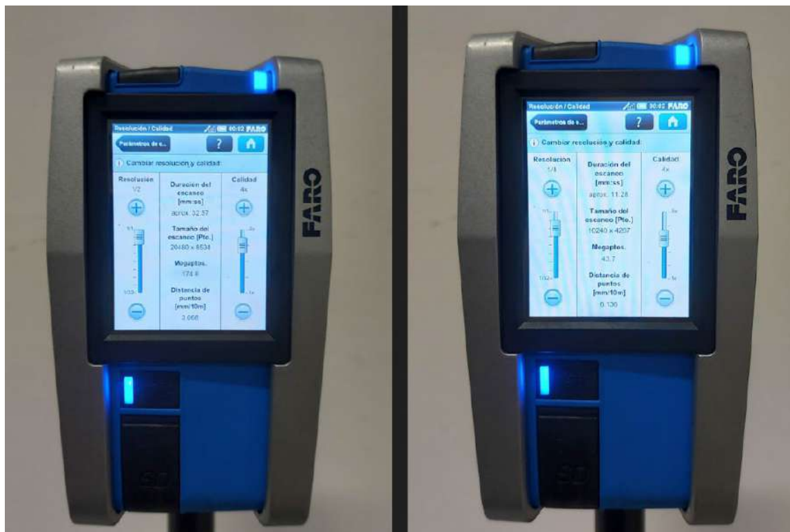
Figura 6.37 Resoluciones empleadas en el escaneo laser. a) Alta resolución b) media resolución.
