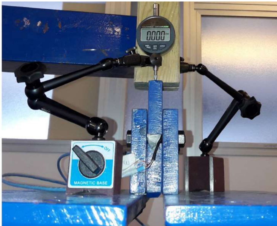
Figura 5.24 Ensayos realizado en la prensa de ensayos del laboratorio para hallar el coeficiente de rozamiento.
