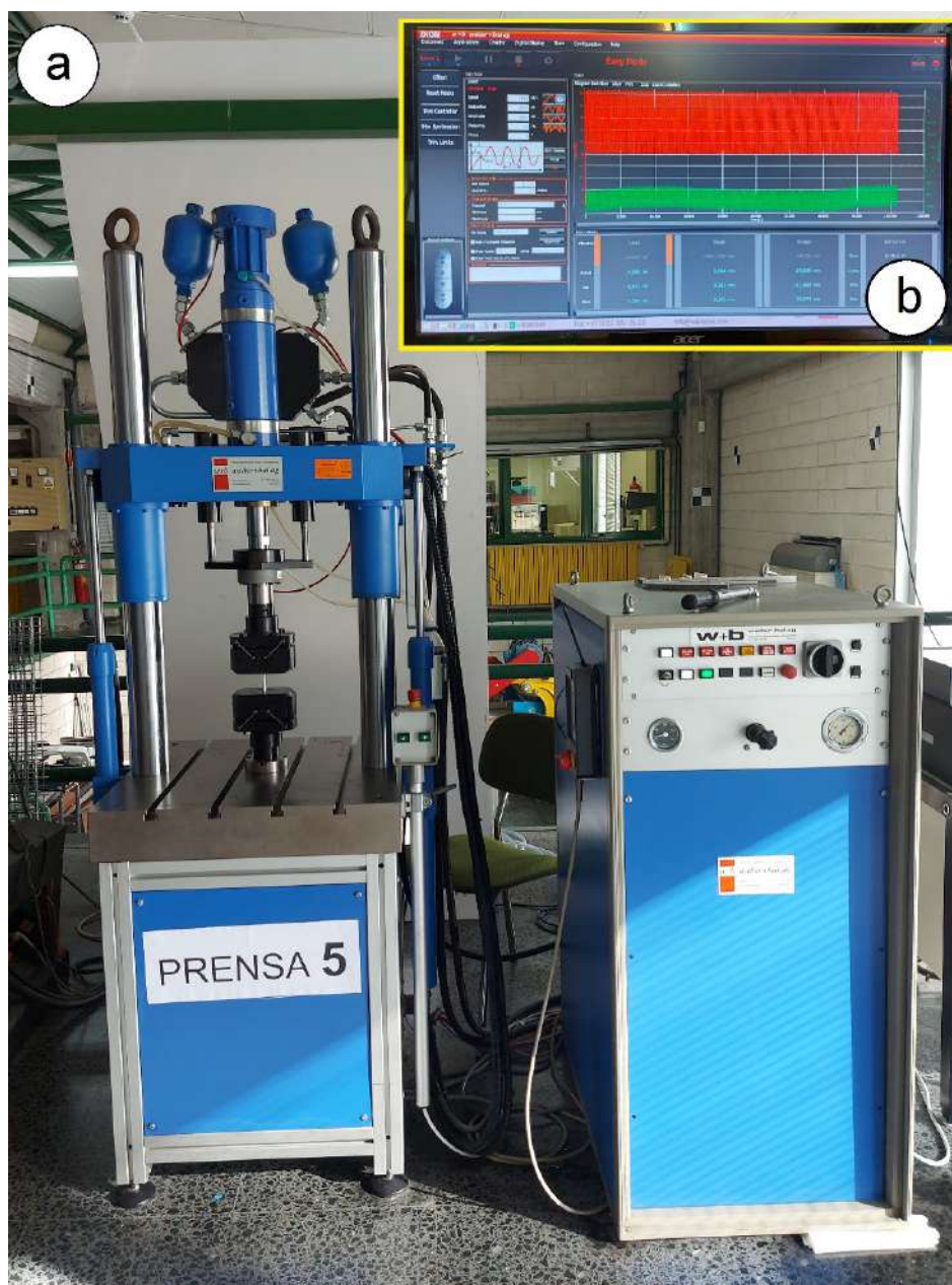
Figura 2.12 a) Imagen de la máquina universal hidráulica de fatiga axial “walter+bai ag” serie LFV. b) Software de control del equipo.
