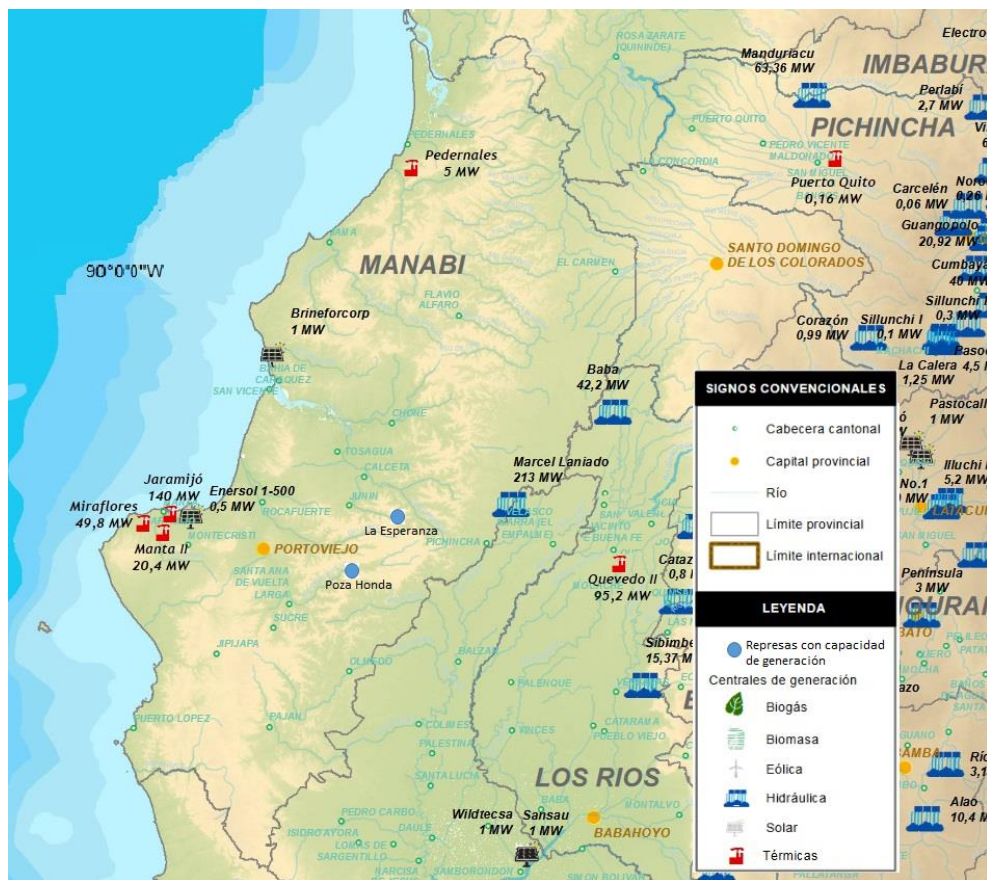
Figura 54. Centrales de generación de la provincia de Manabí. Adaptada de (ARCONEL, 2018e).
