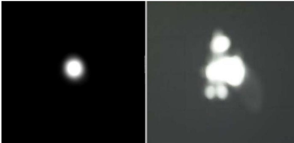
Figura 2.8. Imagen de la mancha solar. Izq. heliostato tras el proceso de canteo. Der. durante el proceso de canteo. Fuente: Valverde (2013).
