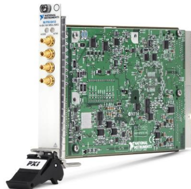
Figura 65. NI PXI-5412 Generador de funciones. (ni.com, 2016).
