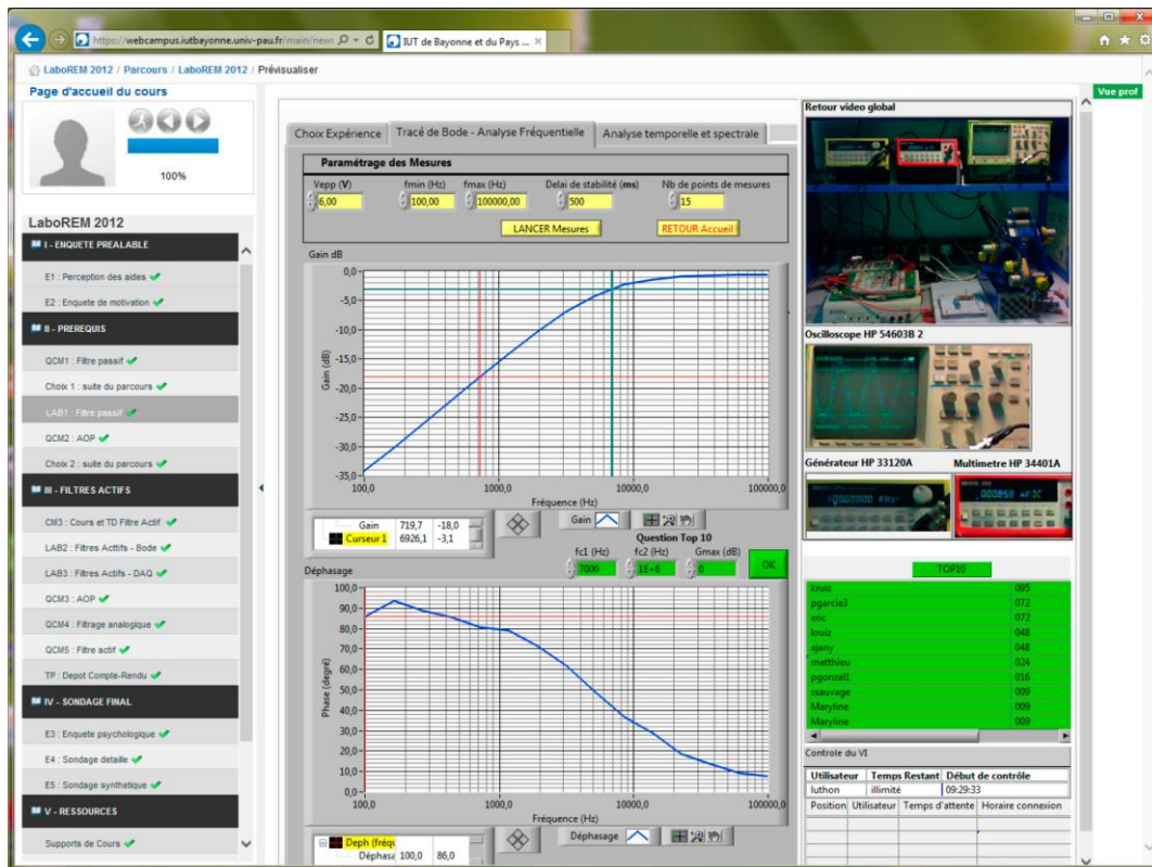
Figura 57. Interfaz de cliente que muestra un panel frontal remoto: (Izquierda) etapas de aprendizaje del escenario pedagógico; (Centro) resultados experimentales (Bode parcelas de un filtro de paso alto; (Derecha) imagen en directo del laboratorio y los instrumentos, lista de Top 10 y la lista de espera de los usuarios. (Luthon y Larroque, 2014).
