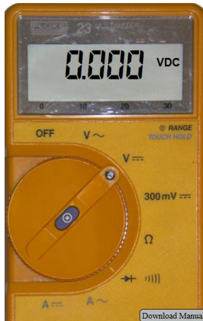
Figura 105. Configuración en el polímetro para la lectura de caída de tensión en corriente continua.
