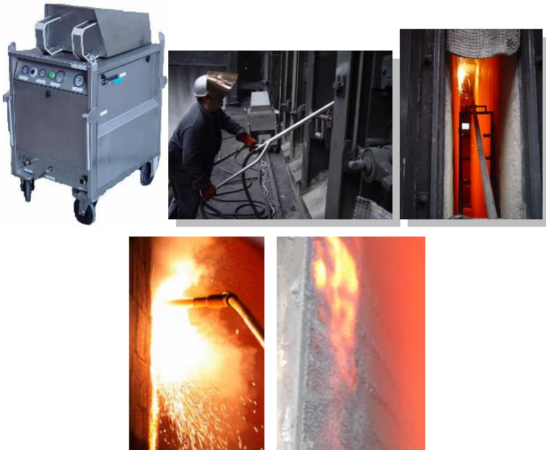
Figura 3.10. Soldadura cerámica. Fuente FIB Services.
