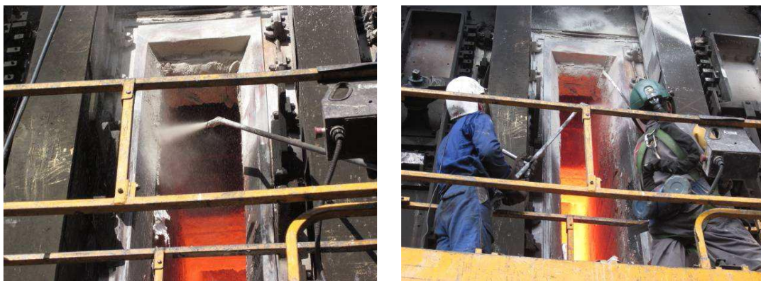
Figura 3.2. Proyección por gunitado. Fuente Daorje.
