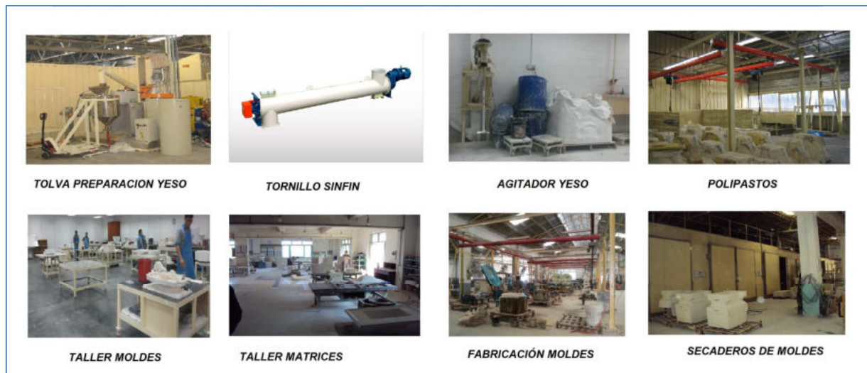
Figura 14. Equipos sección de modelado y fabricación de moldes. Fuente: (Elaboración propia)
