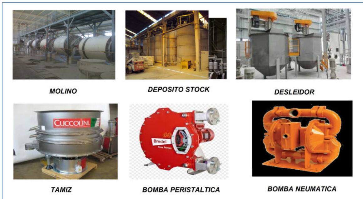
Figura 12. Equipos de la sección de preparación pasta. Fuente: (Elaboración propia)
