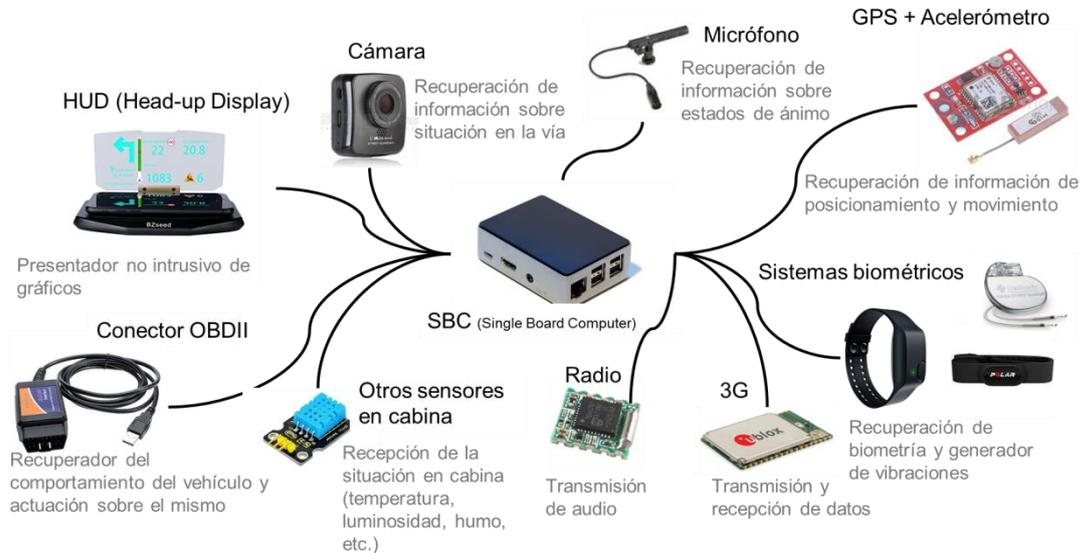
Figura 10.1 Esquema del estado actual del nuevo dispositivo embarcado
