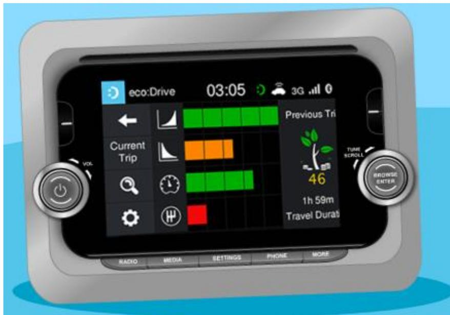
Figura 2.3 Ejemplo de pantalla Eco-Drive de comunicación en tiempo real de FIAT
