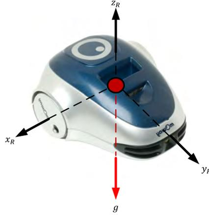
**Figura 7.28:** Referencia para las medidas del acelerómetro.
