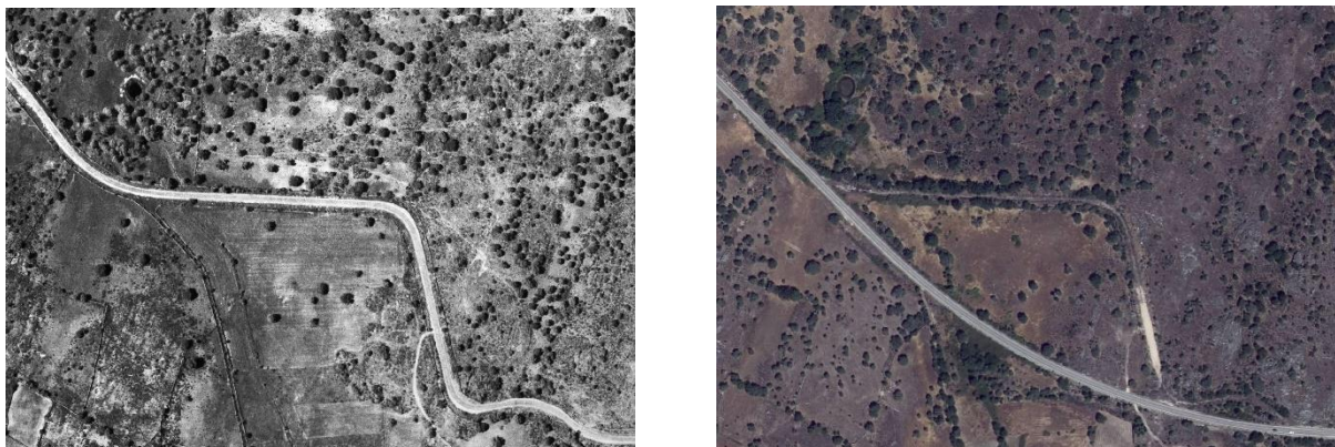
Imagen 8.27: Eliminación de curvatura pronunciada en la carretera CL-517 y posterior colonización vegetal. Municipio de Hinojosa del Duero, comarca de Los Arribes del Duero.
