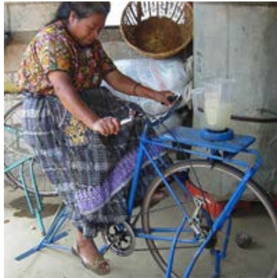
Figuras 22 y 23: Bicimáquina licuadora y bicimolino
