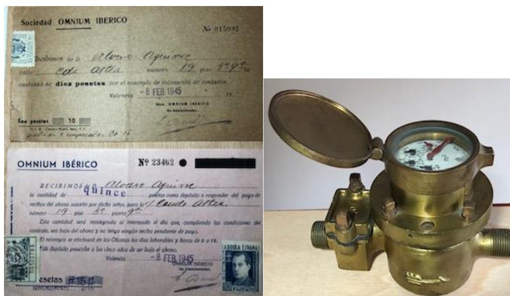
Contador divisionario volumétrico de agua, medidor del flujo que lo atraviesa
