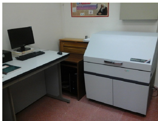
Figura 2.16 (a) Configuración de la esfera integradora para la medida de la transmitancia. (b) Espectrofotómetro SHIMADZU SolidSpec- 3700, perteneciente al ICMM.
