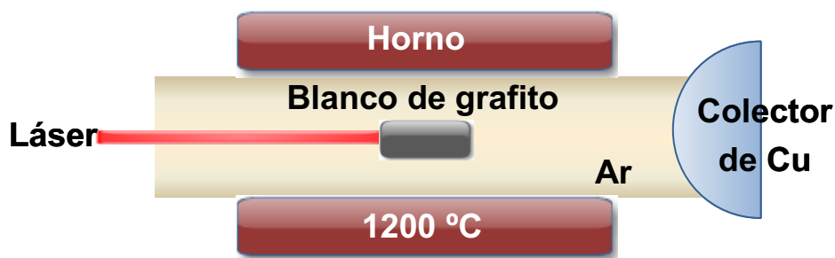
Figura 1.4.2. Montaje experimental para la obtención de nanoespecies de carbono mediante la técnica de ablación láser.
