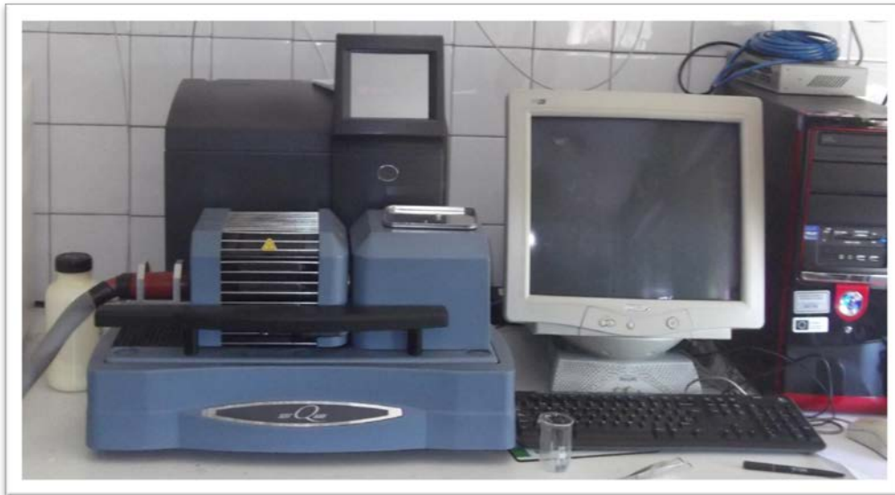
Figura 3.5.2. Equipo de ensayos termogravimétricos TA Instruments SDT Q600.
