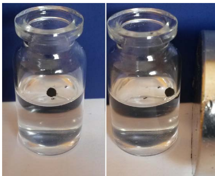
Figura 2.1.25. Atracción de la esfera recubierta frente a un campo magnético.
