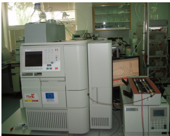
Figura 3.9. Equipo de HPLC con las columnas de HPSEC colocadas en serie
