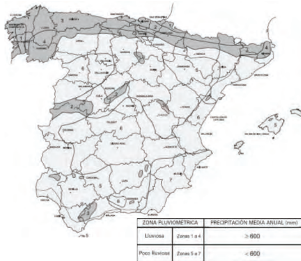
Figura 90 Zonas pluviométricas para firmes
