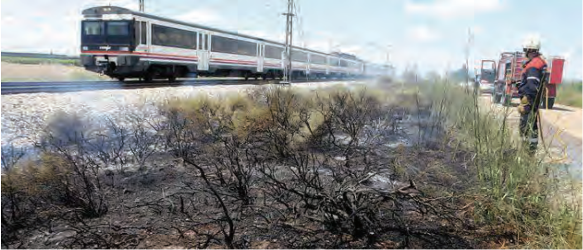
Figura 102 Incendio producido por chispas generadas por un ferrocarril
