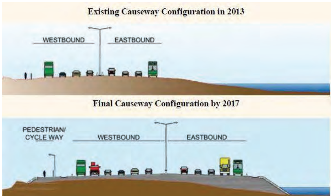
Figura 93 Elevación de la rasante en la Western Ring Route (Nueva Zelanda)
