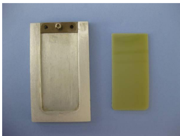
Figura 3.6: Muestra obtenida en estufa y molde de aluminio.
