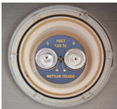
Figura 3.13. Muestra y referencia colocadas en la célula de medida de DSC Mettler Toledo.
