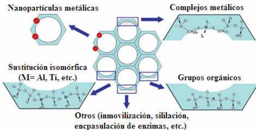
Figura 7. Diferentes rutas para la funcionalización in situ de materiales silíceos mesoporosos.
