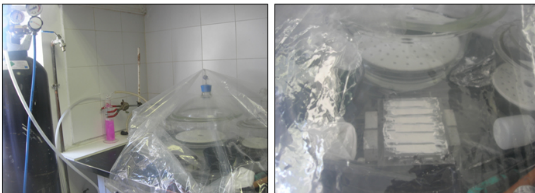
Figura 5.1. Preparación de probetas prismáticas en “Atmosbag”
