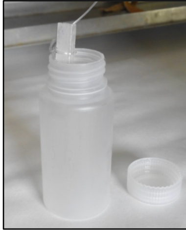
Figura 5.2. Probeta sumergida en el agente agresivo
