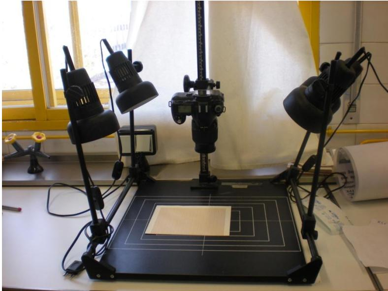
Fig. 18 Montaje para realizar las fotografías a los hidrogeles.
