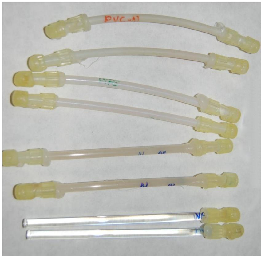
Fig. 7. Cerrado de los moldes de 2 mm de diámetro interior, usados en la polimerización, donde se aprecia el sellado con adhesivo hot melt por la parte exterior.
