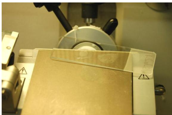
Fig. 13 recogida de un corte de h-PVI<sub>r</sub> en un portaobjeto.
