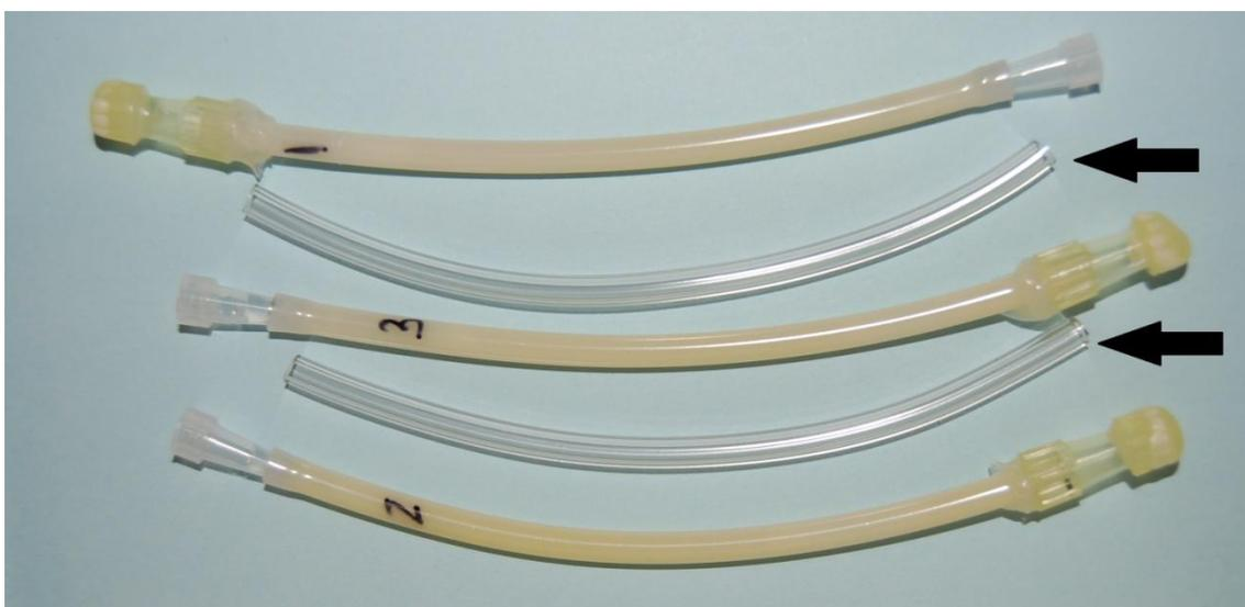
Fig. 74. Comparación del cambio de color que sufre un tubo de PVC empleado como molde, antes (marcados con flechas) y después de la polimerización del PVI.
