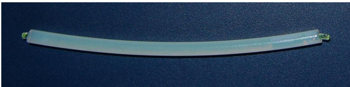
Fig. 39. Fotografía en la que se puede observar el efecto de expansión longitudinal que sufre el h-PVI polimerizado en un molde de PTFE de diámetro 2/4.
