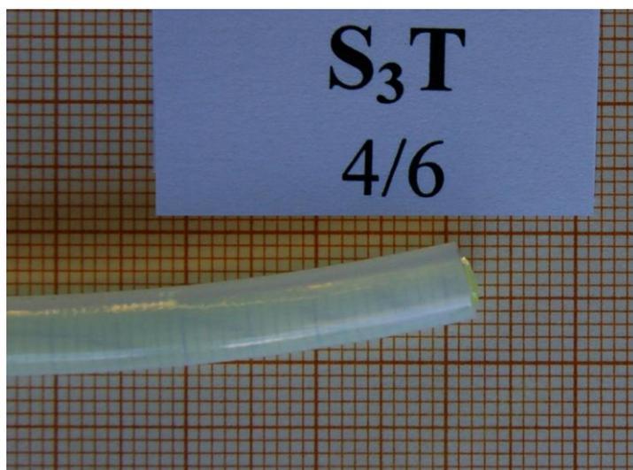
Fig. 40. Fotografía en la que se puede observar el efecto de expansión longitudinal que sufre el h-PVI polimerizado en un molde de PTFE de diámetro 4/6.
