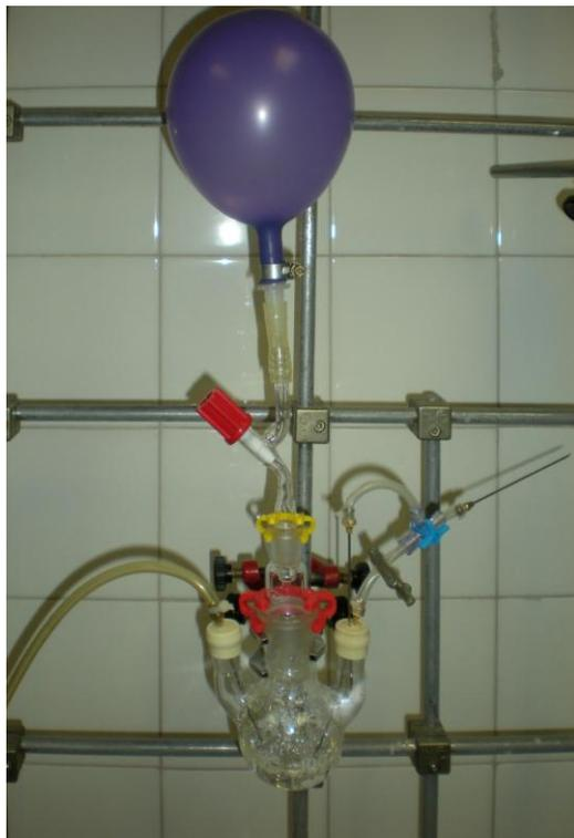
Fig. 58. Montaje para mejorar la eliminación del oxígeno en los moldes empleados en la polimerización del PVI.
