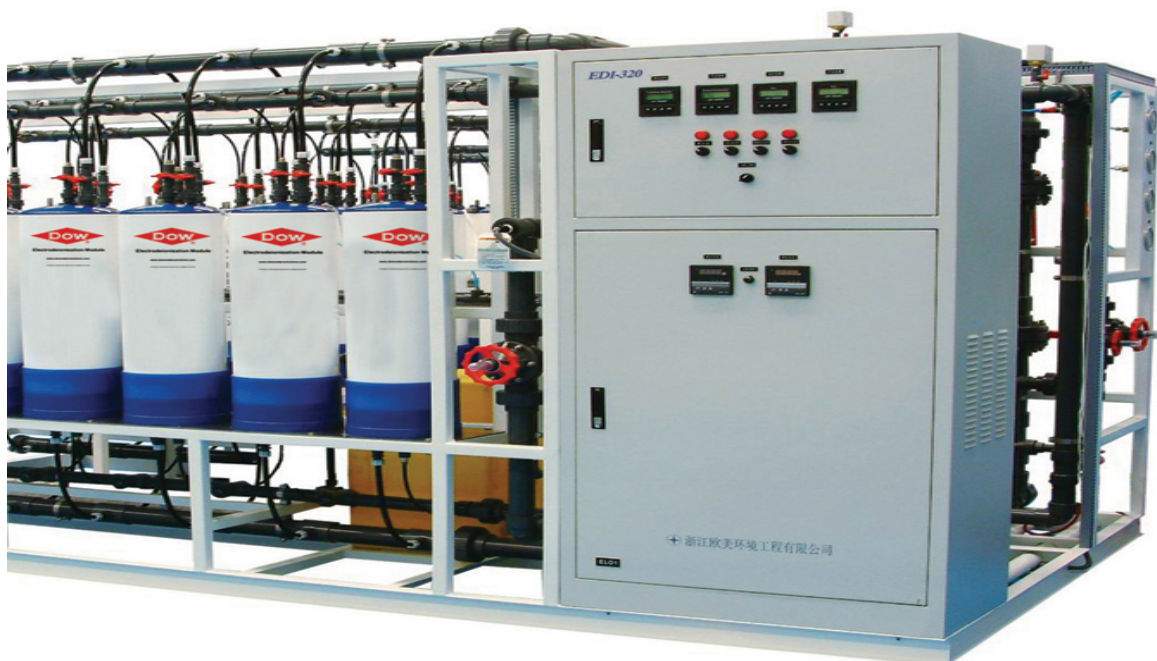
Fig.4.18. Equipo de Electrodesionización (EDI) de la casa DOW.
