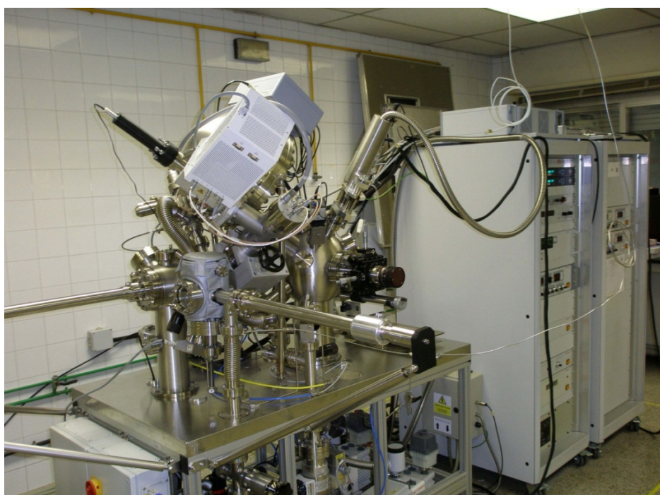
Fig. 8.11. Espectrómetro ESCAPROBE P de Omicrom
