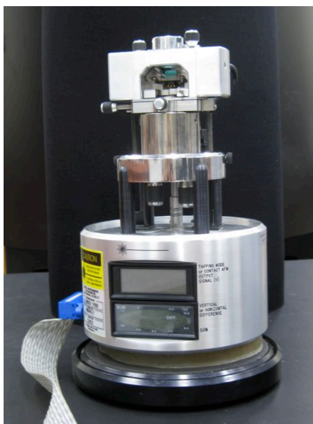
Fig. 8.15. Equipamiento típico de AFM (Veeco)
