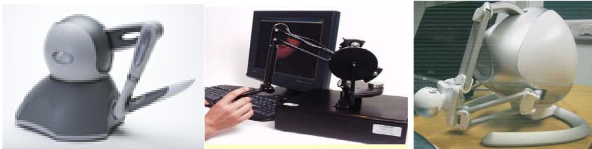
**Figura 2.** Dispositivos hápticos comerciales de realidad virtual. (a) Phantom Omni Haptic Device. (b) Phantom Premium 1.5/6DOF. (c) Novint Falcon
