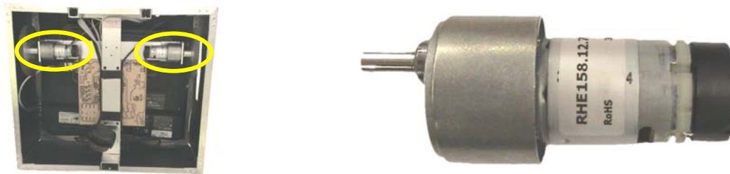
Figura 7. Ensamblaje de los motores en el robot (izquierda) y detalle del motor utilizado (derecha).
