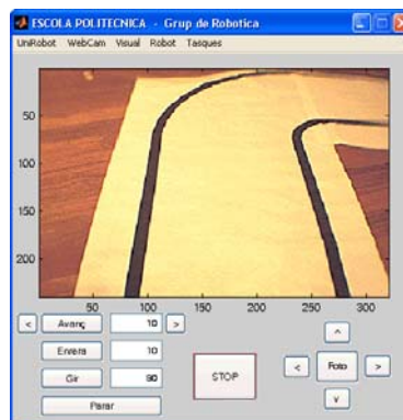
Figura 8. Ejemplo de aplicación de control que se ejecuta en un ordenador de sobremesa y permite la supervisión remota del robot móvil.
