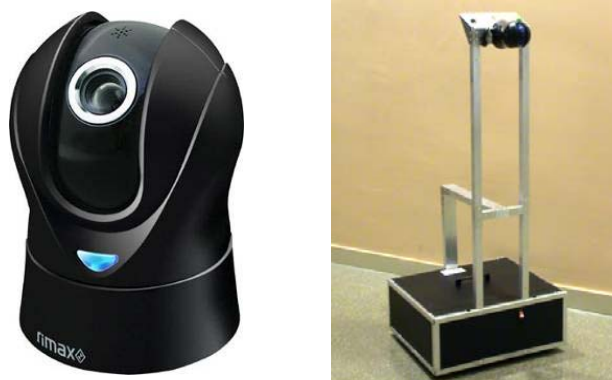
Figura 2. Cámara utilizada (izquierda) y su posición en el robot (derecha).
