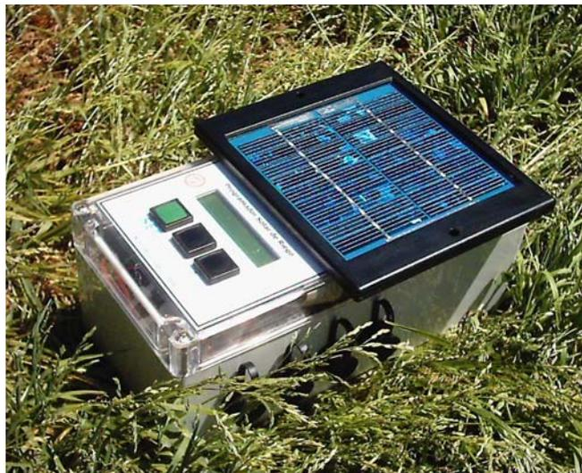
**Figura 3.** Programador de riego autónomo.
