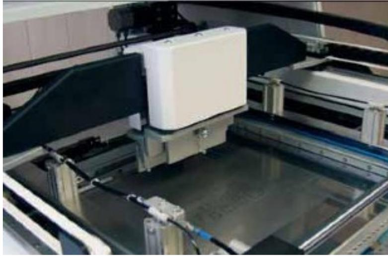
**Figura 2.** Máquina de serigrafía de pasta de soldadura.
