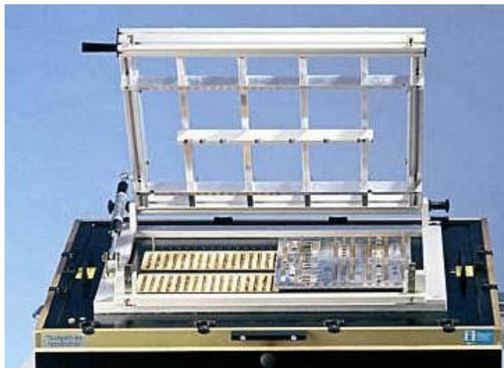
**Figura 5.** Cama de pinchos para inspección de circuitos.
