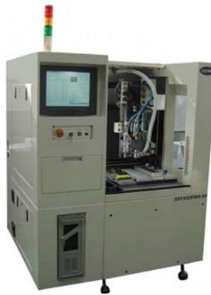
**Figura 1.** Máquina de taladrado de circuitos impresos.
