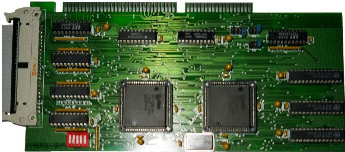
Figura 2. Placa de adquisición de datos usada en el analizador lógico virtual
