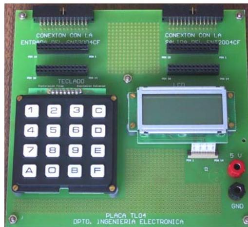
**Figura 6. Placa de interfaz con un teclado matricial y un LCD (Liquid Cristal Display)**
