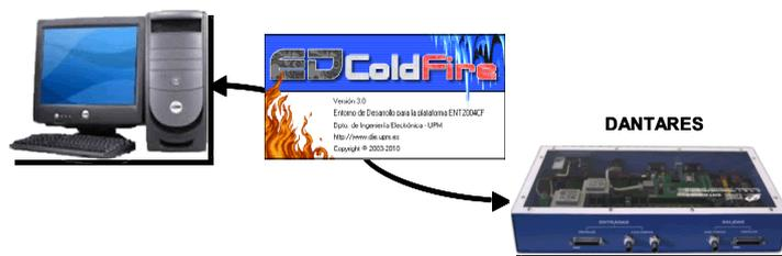
**Figura 1. Puesto de laboratorio: ordenador con el entorno EDColdFire y la plataforma DANTARES.**
