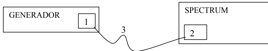
Figura 3.- Conexión para el cálculo de la pérdida de los cables
