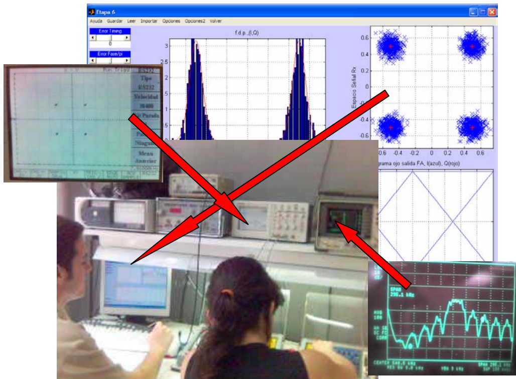
Figura 6. Experimentación instrumental, simulación y verificación teórica de una modulación QPSK en la asignatura de laboratorio de comunicaciones 1. ETSETB. UPC.
