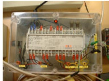
**Figura 1.** Convertidor RS232-RS485 (casa SISTENA)    **Figura 2.** Multiconvertidor de medida (Casa SACI)
