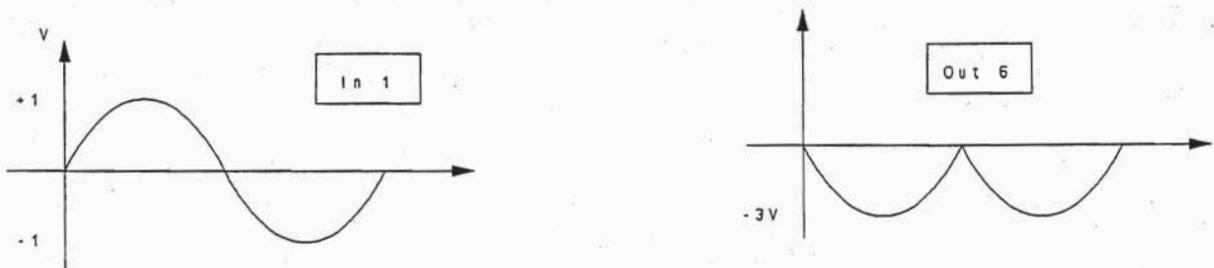
**Figura 3.-** Formas de onda de entrada (IN1) y de salida (OUT6) al circuito.
