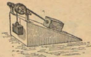
El *plano inclinado* puede emplearse también como órgano para transformar un movimiento rectilíneo en una dirección por otro en otra distinta, como se ve por la figura adjunta.
