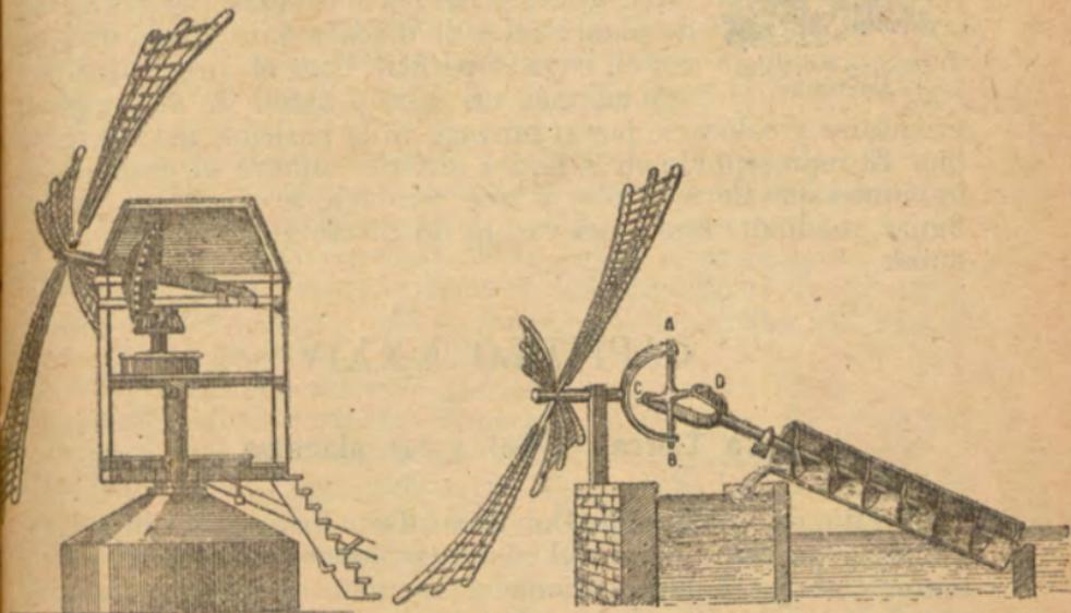
nas maneras de las varias que hay de comunicar el movimiento rotativo de las aspas á las máquinas. El primero de ellos repre-
