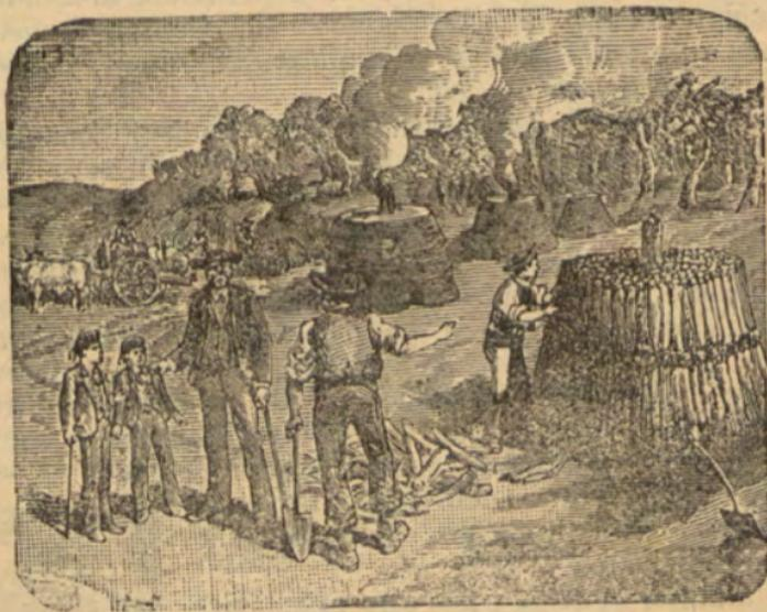
madera, cubriéndola de tierra para librarla del contacto del aire; porque así, no verificándose la combustión sino muy imperfectamente á costa del propio oxígeno que la madera lleva en sí, sólo quedan de ésta el carbono y las otras sustancias minerales que la forman. Por eso, entre las varias maneras de fabricar el
