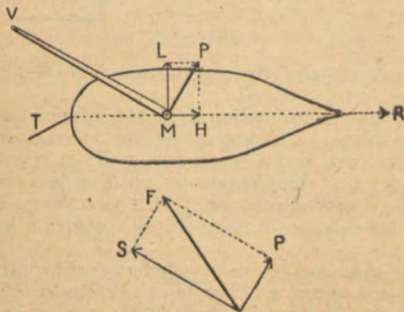
en que nos suponemos colocados, sólo nos presenta un línea.  $F$ , en la figura auxiliar, representa la fuerza del viento, que se descompone en dos parciales: una  $S$  completamente inútil que se ejerce en la misma dirección de la vela, y otra  $P$  que se dirige normal ó perpendicularmente
