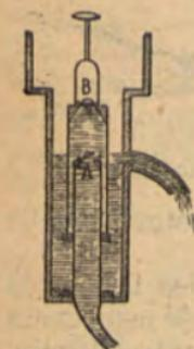
En esta otra bomba, la dilatación y reducción del espacio interior se produce por el resbalamiento del tubo en cuya tapa superior va la válvula *B* á lo largo del que lleva la de aspiración *A*, tubos que están ambos dentro del cuerpo de la bomba.
