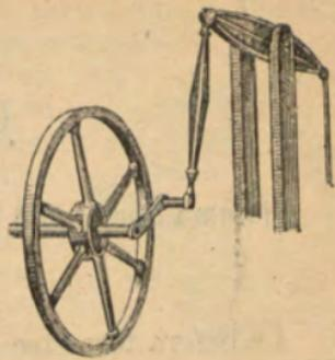
»Pero es más sencilla la transformación del movimiento rectilíneo de vaivén del émbolo en el rotativo continuo del eje de la máquina, bien por medio de la biela y manivela, bien por medio del mismo balancín, sustituyendo el paralelogramo articulado por unas guías que obliguen á marchar derecho al vástago del émbolo—continuó Fernandito; y ac.
