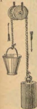
Fig. 2. Polea fija.
