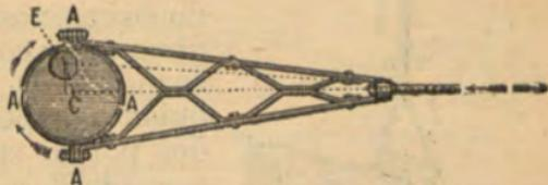
Esta figura representa una excéntrica dispuesta para producir un movimiento de vaivén, como lo indican las flechas dibujadas en el extremo del vástago. Esa excéntrica, en lugar de girar alrededor de su centro C, gira alrededor del punto E, y mediante el collar AAA transforma el movimiento circular continuo de que está animada en el de vaivén dicho.
