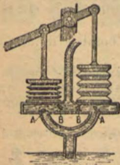
Otra bomba muy semejante á las descritas es la representada en este grabado. Tampoco tiene émbolo, sustituyéndolo una tela flexible é impermeable *C*, sujeta por sus orillas al cuerpo de la bomba, y por su centro á una chapa en que va la válvula *B*, que se abre y da paso al agua al bajar el vástago á que dicha chapa está unida. La válvula *A* es la de aspiración.
