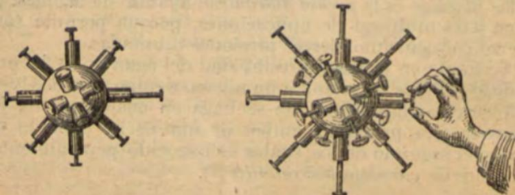
la entrar á cualquiera de ellos que se hubiere dejado fuera, probando ese hecho que a presión que se haga en cualquiera parte del líquido se transmite á toda la masa de él
