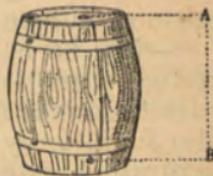
El peso del aire impide salir al líquido de la cuba por el orificio B, pero si se abre otro A en lo alto de la cuba, el aire gravitará sobre la superficie del líquido, y entonces saldrá éste por su propio peso.
