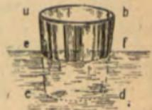
El vaso flotante que aquí se representa ha perdido de su peso el del volumen de agua *efcd*, que es la parte del vaso que está sumergida. El vaso vacío pesa precisamente lo mismo que el volumen *efcd* de agua.
