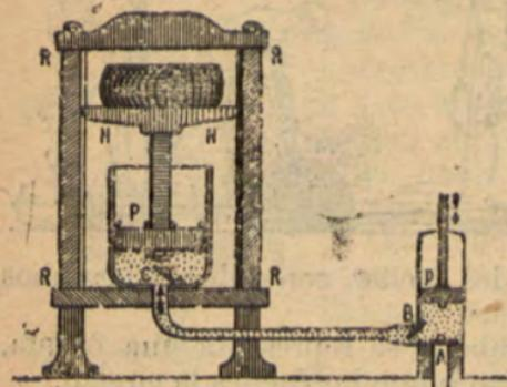
p, bomba con su émbolo; A, válvula aspirante; B, válvula impelente; P, cuerpo cilíndrico en que juega el émbolo que sostiene el platillo NN; RR, armazón de la prensa y guías por donde corre el platillo de ella; C, válvula que impide que salga el agua que va entrando en el cuerpo del cilindro en que juega el émbolo P y que se abre para dar paso á ese agua.
