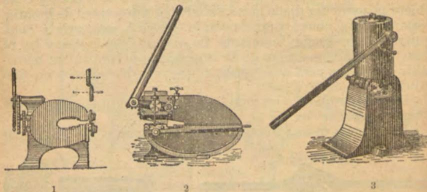
tijeras montadas en la misma máquina para cortar simultáneamente, y por sendas líneas paralelas, una plancha metálica convirtiéndola en tiras. La figura marcada con el número 3 representa unas *tijeras hidráulicas*, aparato que funciona por el mismo principio que la prensa hidráulica. En el grabado sólo está figurada una de las dos palancas que lleva, y cuyo objeto es poner
