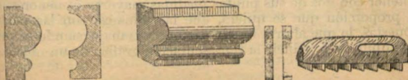
Plantillas y sillar labrado conforme á ellas.
