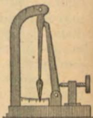
da. La tercera es una combinación de palancas, no para ganar ventaja en la transmisión de la energía, sino para amplificar movimientos pequeños convirtiéndolos en grandes, caso muy frecuente en los instrumentos de precisión.
