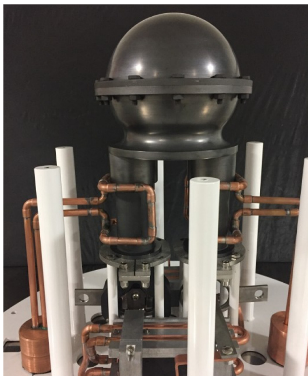
Figura 9. Prototipo del dispositivo SunCell, desarrollado por la firma BLP con destino a la producción de “hidrinos” a partir del hidrógeno convencional. El cuerpo esférico es un reactor de carbono en el que se forman los “hidrinos” y que actúa como cuerpo negro en la captación de la energía producida. Esta energía se reemite en forma de luz visible y es aprovechada por células fotovoltaicas, no mostradas en la imagen. Según la firma BLP.
