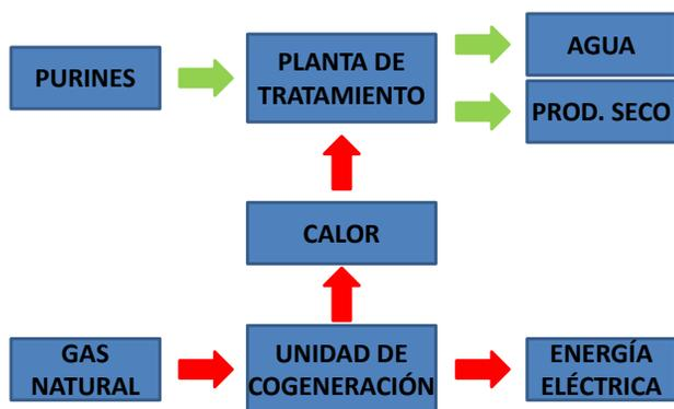
Figura 1. Esquema de funcionamiento de una planta tipo.
