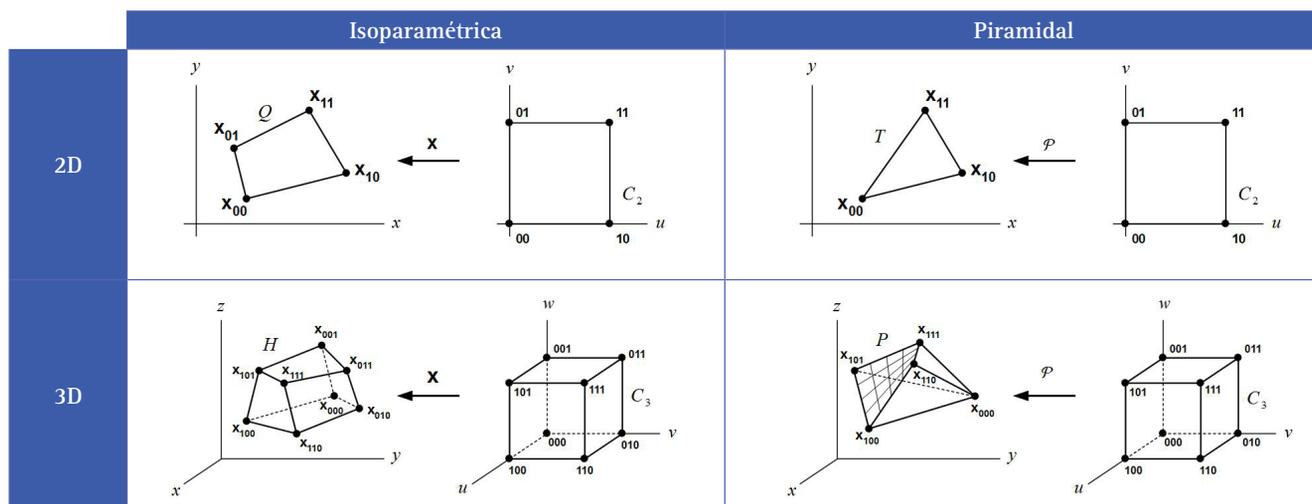
Figura 3. Transformaciones isoparamétrica y piramidal en 2 y 3 dimensiones.
