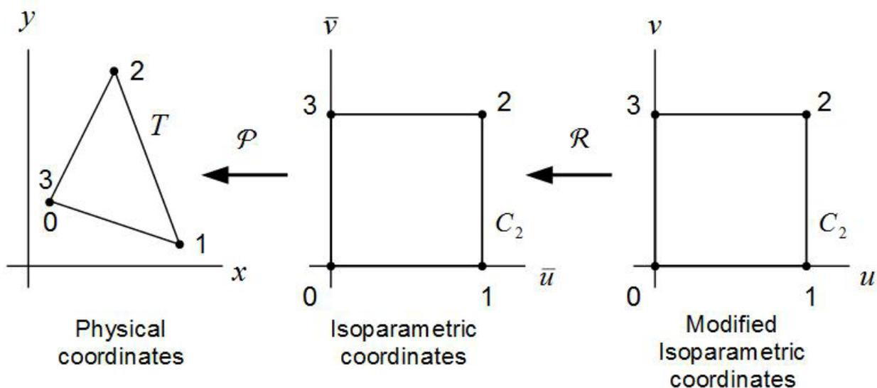
Figura 2. Transformaciones de regularización geométrica y algebraica.
