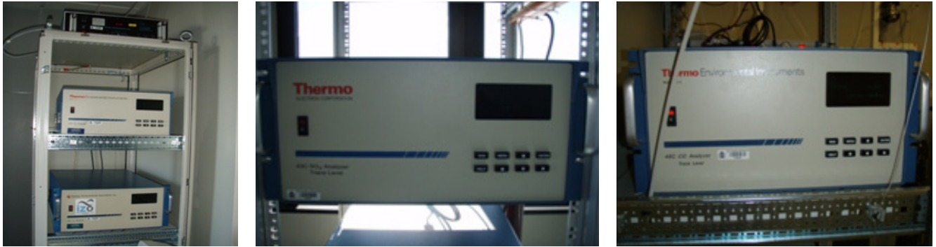
Figura 10. Instrumentos para la medida de gases reactivos. Derecha: fotómetro de absorción UV (medida de ozono). Centro: analizador de correlación de filtro de gas (medida de monóxido de carbono). Derecha: analizador de fluorescencia pulsada (medida de dióxido de azufre).
