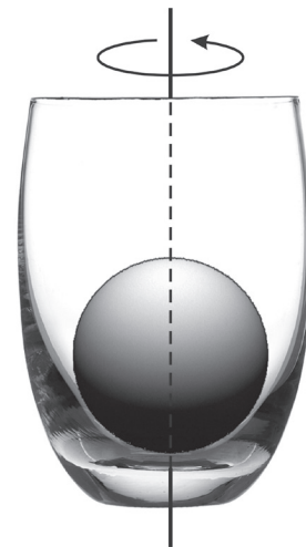
Figura 3a. Sistema “Tierra-taza-esfera” en su estado de mínima energía (simetría respecto al eje vertical).
