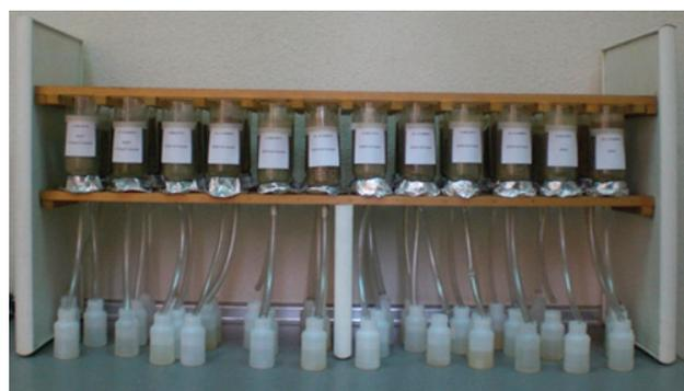
Figura 7. Ensayo en columnas de lixiviación.
